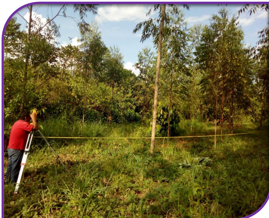
Fotografía 9: Calculando la altura con teodolito con un año de edad
