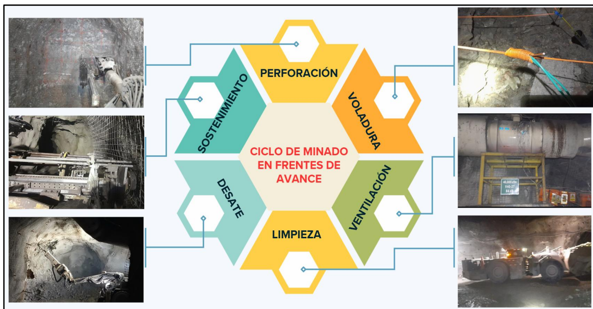
Figura 14 Ciclo de minado en frentes de avance
