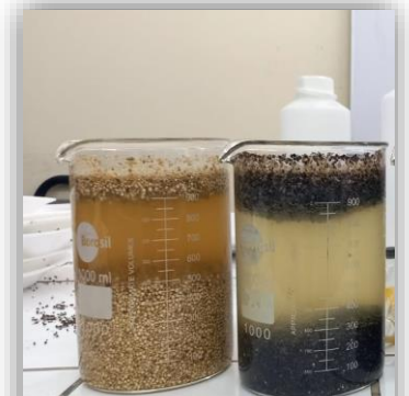
Lavado y desinfección de la muestra con NaClO al 0,02%
