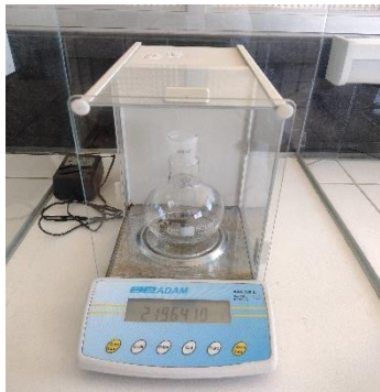
Se pesó el balón vacío
