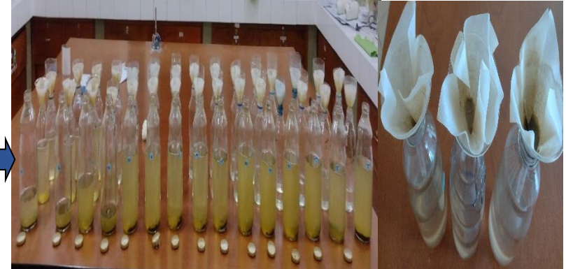
Se filtró la muestra con papel filtro de 0,22 \mu\text{m} de porosidad
