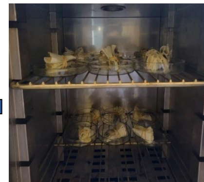
Se dobló el papel filtro el papel filtro, se dejó secar a 103 °C por 30´
