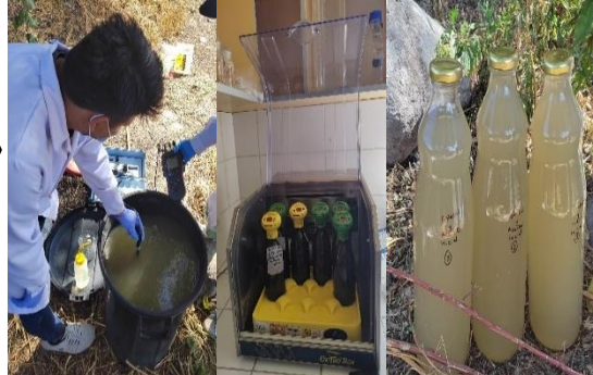
Proceso de medición de los parámetros iniciales de temperatura, pH, STD, DBO 5 y se tomó la muestra para determinar la concentración de grasas y aceites.
