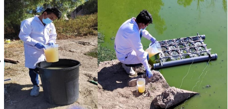
Se colocó las aguas residuales a cada unidad experimental, proveniente de la muestra compuesta y a cada blanco
