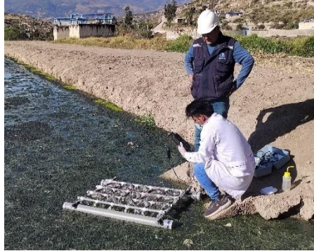
Se midieron los parámetros finales de temperatura, pH, STD y DBO 5
