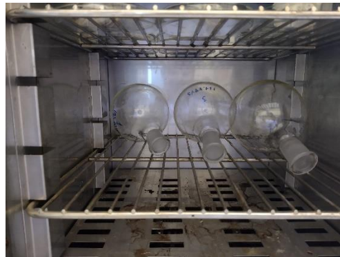
Se secó el balón del equipo Soxhlet vacío a 105 °C por 1 hora, dejar en el desecador por 30´
