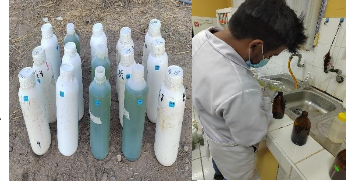
Se tomaron las muestras para medir el DBO 5 final mediante el método respirométrico
