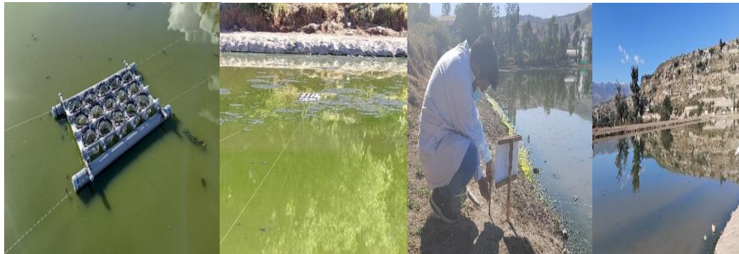
Se amarraron los cuatro extremos del armazón con hilo de nylon de 0,9 mm y se colocó en el centro de la laguna facultativa 1, sujetando los extremos a estacas para asegurar la estabilidad del armazón y se inició con el experimento.
