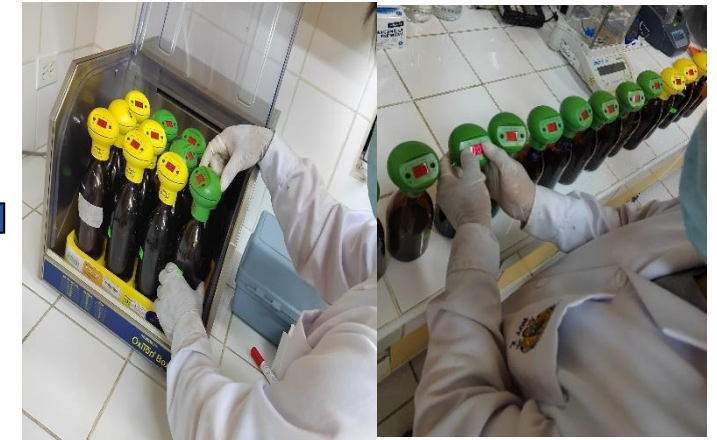
Se cerró herméticamente y se programó la medición del DBO 5 y se puso a incubar a 20 °C con agitación constante.
