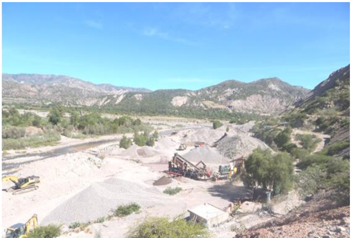
Fotografía 37: Cantera de producción de agregados (gruesos y finos)
