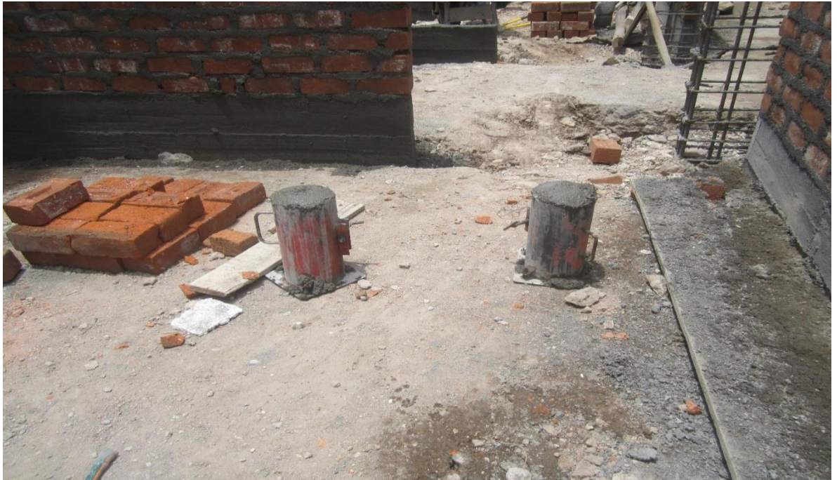
Fotografía 16: toma de muestra de columna de vivienda número 10, preparación en cilindros traslado con baldes.
