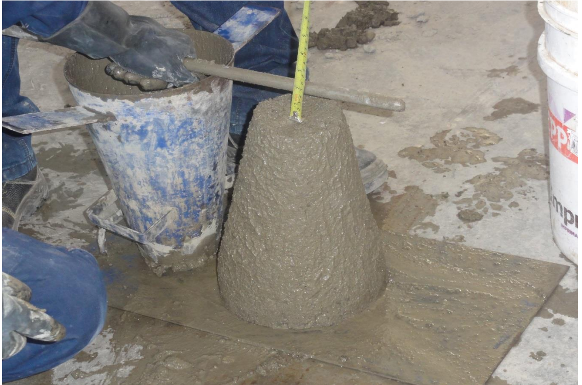
Fotografía 03: Midiendo la altura del concreto
