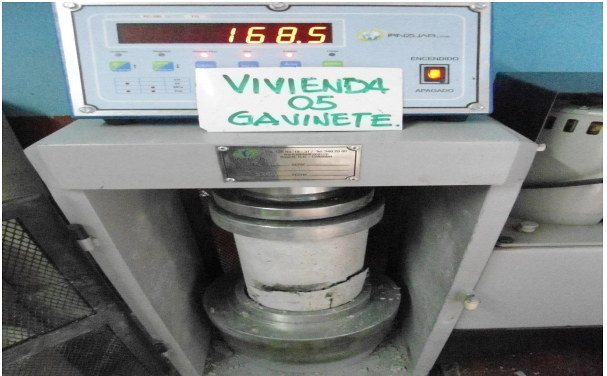
Fotografía 34: Prueba de compresión vivienda 05 (gabinete)
