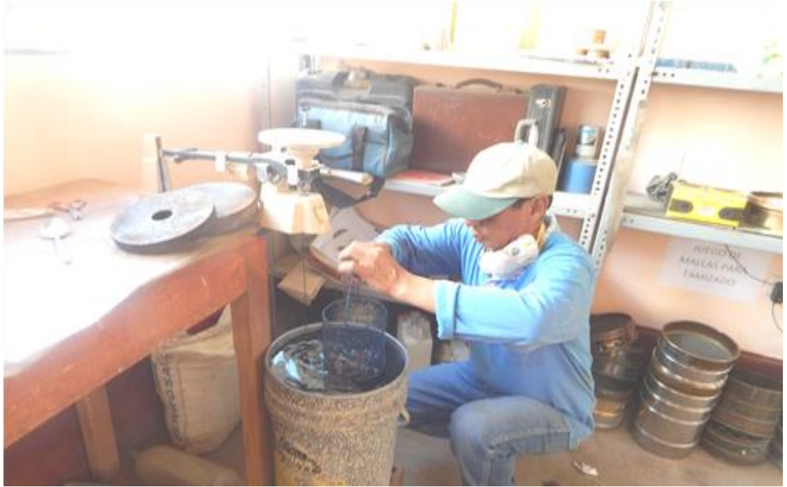
Fotografía 44: Peso específico y absorción del agregado grueso
