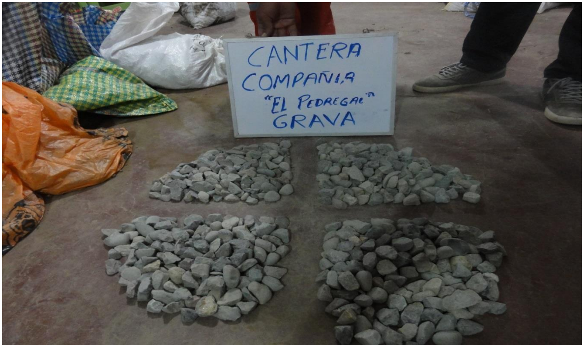
Fotografía 40: Cuarteo del agregado grueso para realizar el secado y pesado
