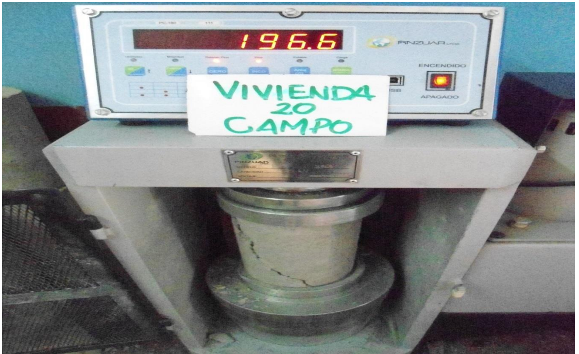
Fotografía 36: Prueba de compresión vivienda 20 (campo)
