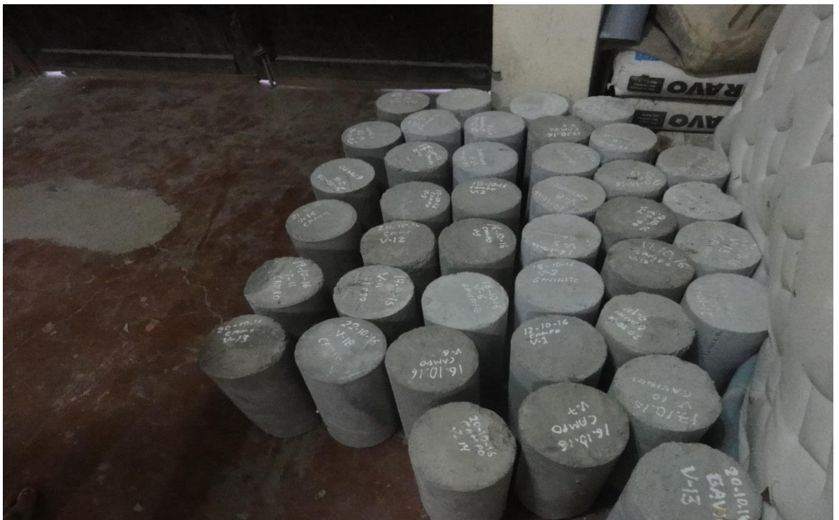
Fotografía 31: Muestras de concreto listas para ser llevadas al laboratorio
