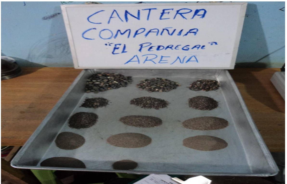
Fotografía 43: Resultado de granulometría de la arena
