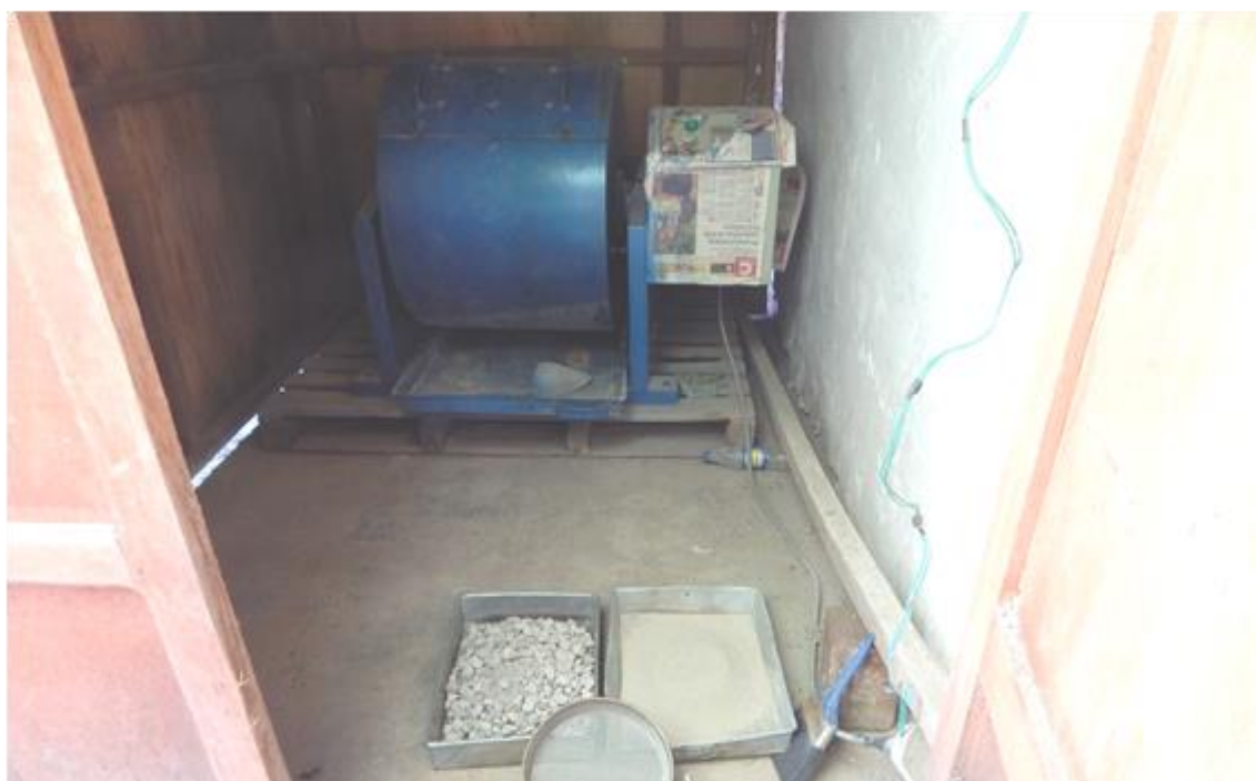
Fotografía 46: Muestras de agregados grueso sometidos a resistencia con sulfato de sodio
