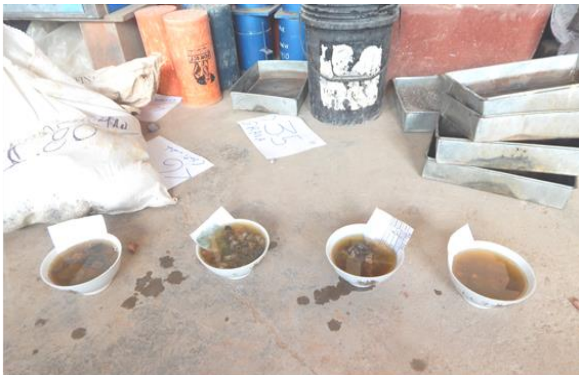
Fotografía 46: Muestras de agregados grueso sometidos a resistencia con sulfato de sodio
