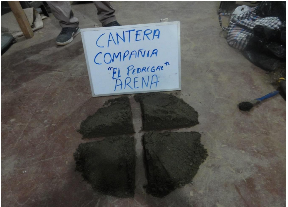
Fotografía 39: Cuarteo del agregado fino (arena) para realizar el pesado y secado
