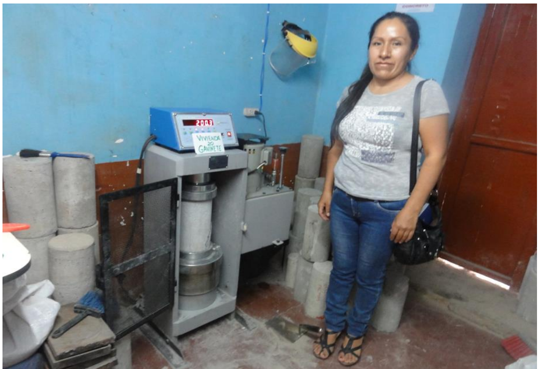
Figura II-5: Realizando la prueba de ensayo del concreto a compresión en el laboratorio
