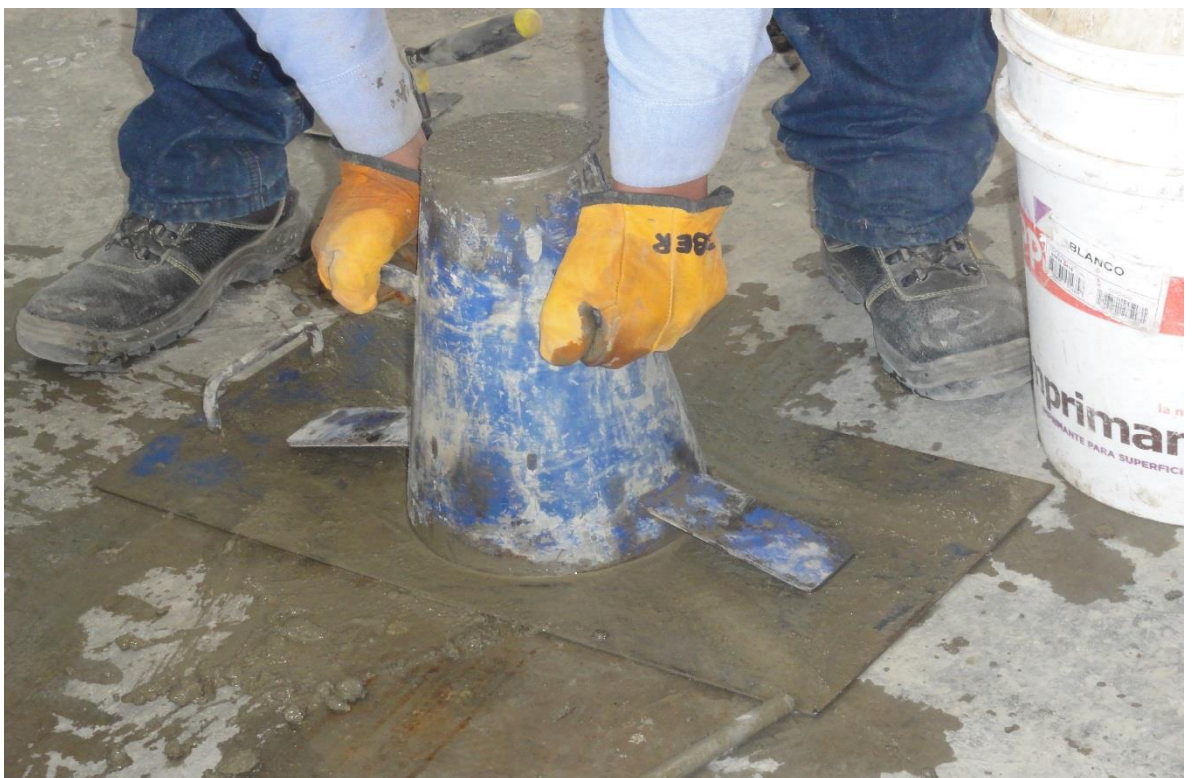
Fotografía 02: Ensayo con el cono de abrams, para medir la consistencia del concreto.
