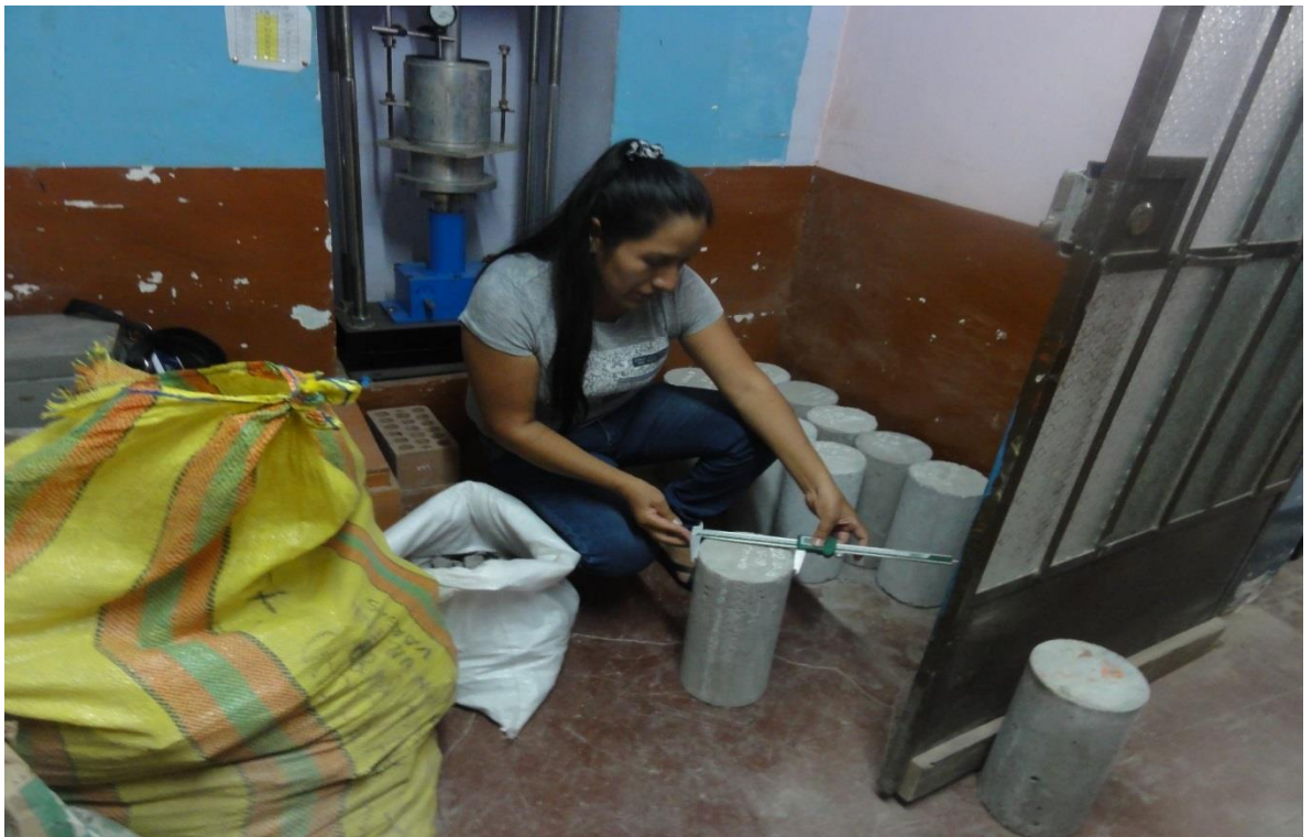
Fotografía 33: Midiendo las muestras en el laboratorio
