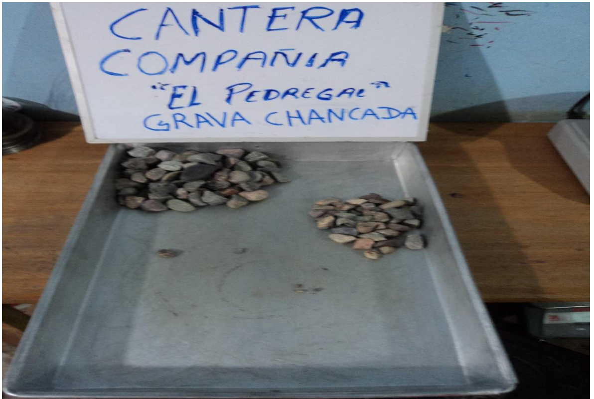
Fotografía 42: Prueba para el contenido de humedad y absorción del agregado grueso
