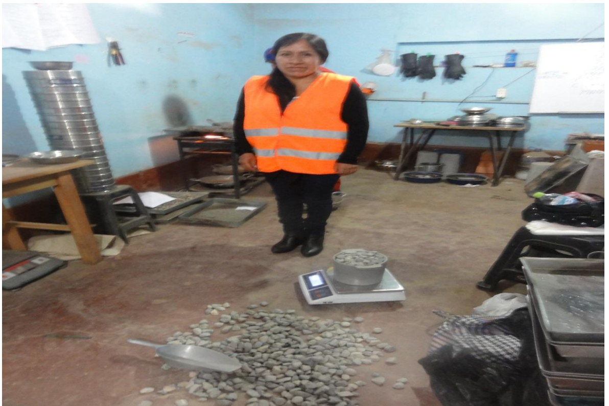
Fotografía 41: Peso unitario suelto del agregado grueso
