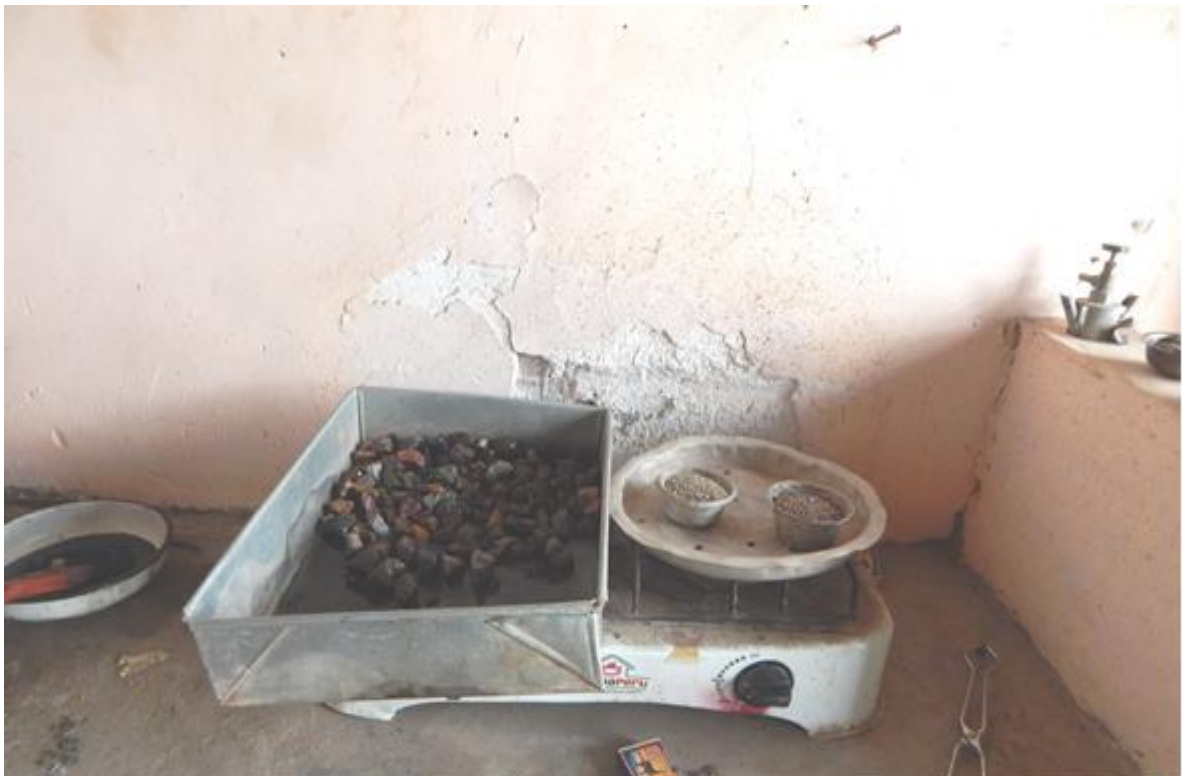
Fotografía 45: Secado y su posterior pesado del agregado grueso y fino
