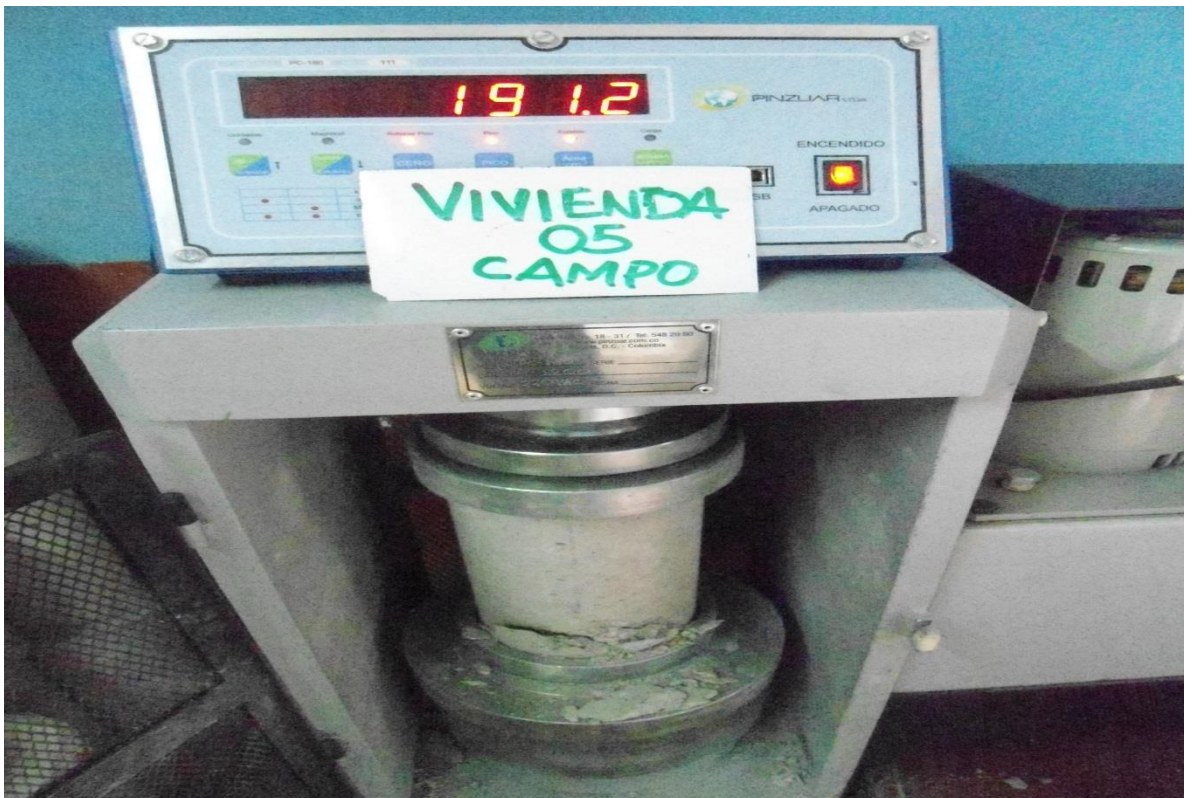
Fotografía 35: Prueba de compresión vivienda 05 (campo)
