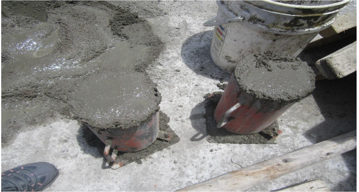
Fotografía 20: toma de muestra de columna de vivienda numero 13
