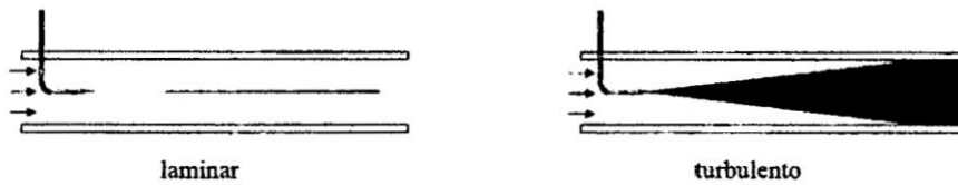
Figura 2.2: Régimen laminar y régimen turbulento. En régimen laminar el movimiento de las capas del fluido es ordenado, en régimen turbulento no
