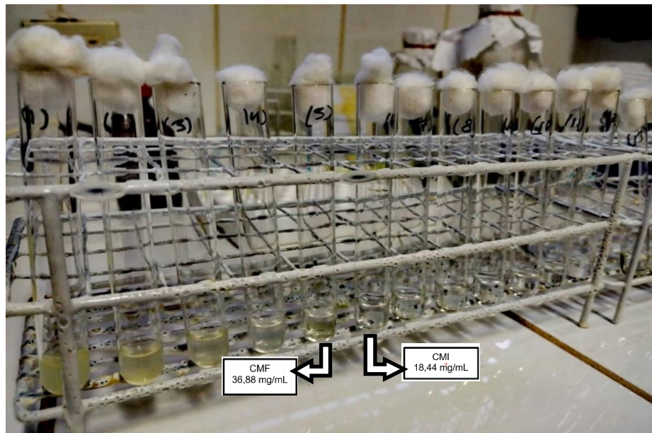
Fig 1. Se muestran los tubos de prueba en una gradilla luego de incubarlo a 37 °C por 24 horas, para seleccionar el tubo con ausencia de turbidez.
