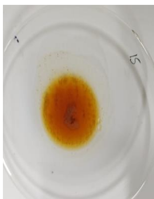
Fig 2. Se muestra una placa de vidrio con la reacción negativa para cumarinas.
