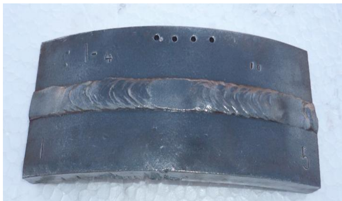
Fig. 4.17. Estado inicial de la muestra antes de someter al ataque, SSPC-SP-3
