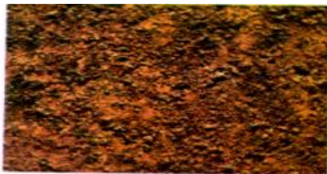
Figura 2.19. Grado de óxido D (ISO 8501-1, 2002)
