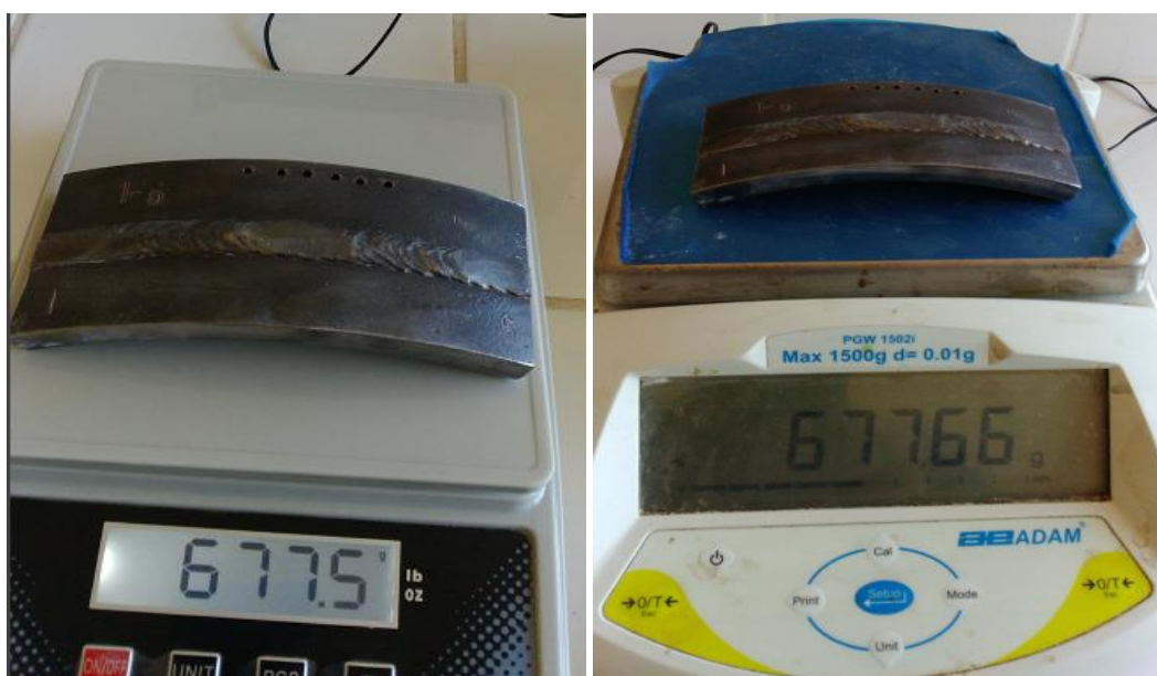
Figura 4.20. Realización de las pesadas, y comparación de las balanzas usadas, teniendo un porcentaje de error de pesadas de 0.02%
