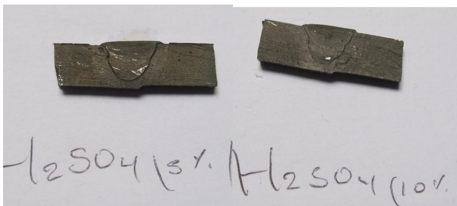
Figura 4.4. Ataque de la muestra con ácido sulfúrico diluido
