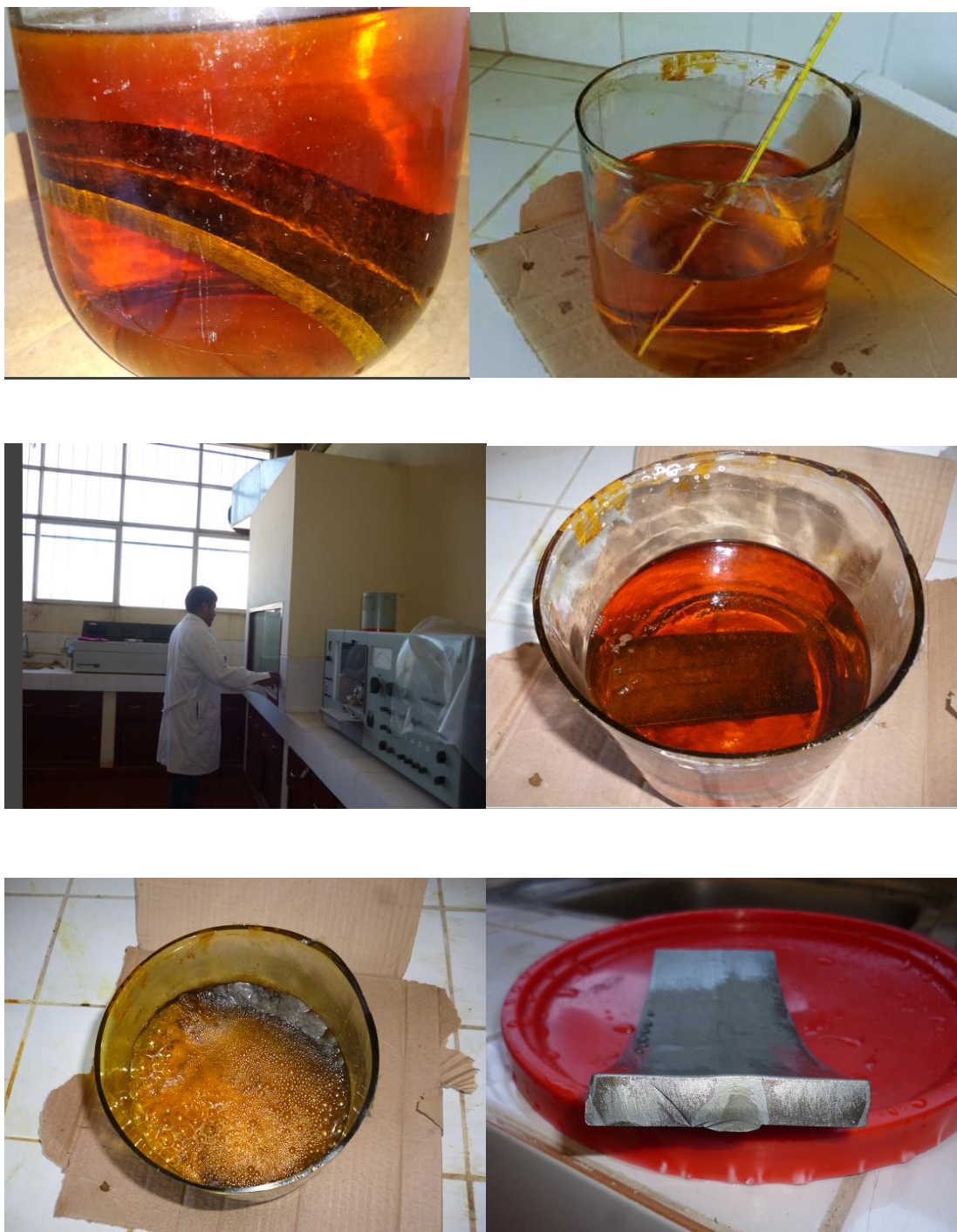
Figuras I.2. Se observa, el recipiente de vidrio conteniendo la muestra y el agua regia, iniciándose la reacción con la aparición de las primeras burbujas hasta una reacción exotérmica con producción de espumas, en cada inicio y final se tomó la temperatura de la reacción.
