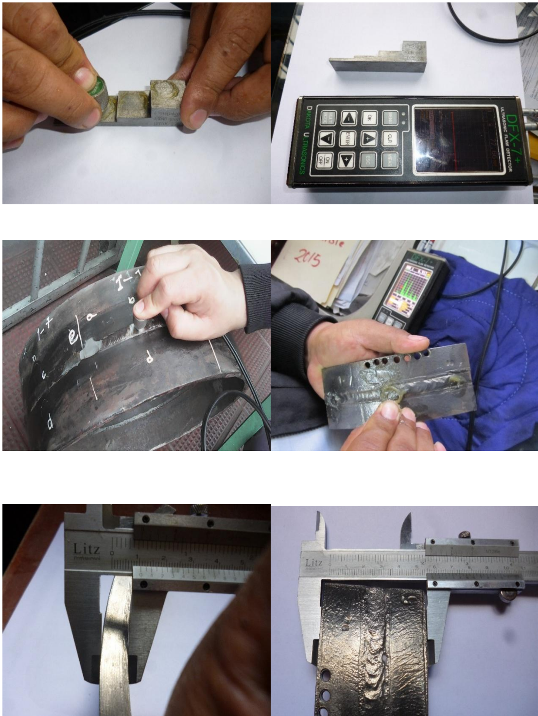
Figuras I.5. Se observa, la realización de la inspección por ultrasonido industrial, medición de espesores en los diferentes puntos de la muestra, realizados en la ciudad de Lima, y también se observa las mediciones realizadas con vernier la muestra ensayada en el laboratorio de la FIQM, dichos datos son usados los promedios para la realización de la velocidad de corrosión.
