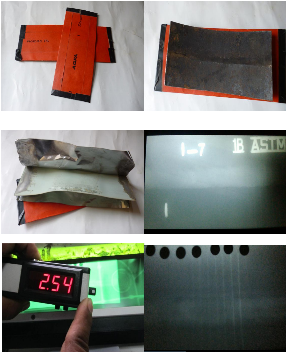
Figuras I.4. Se observa, la identificación de la placa radiográfica usada para la inspección por radiografía industrial, el tamaño usado, las características de la muestra inicial cumple con el criterio de aceptación, tanto en interpretación y densidad del film, después de los ensayos se observa el aumento del tamaño del agujero e indicaciones en la placa; socavados y quemón, las cuales son rechazadas al evaluar con el criterio de aceptación del API 1104.
