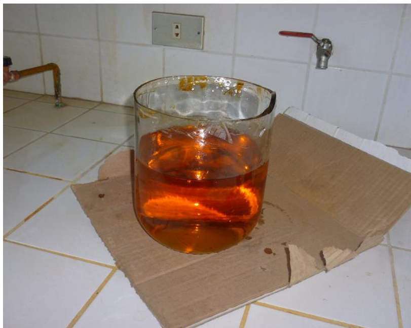
Figura 4.6. Recipiente para el ataque químico conteniendo agua regia
