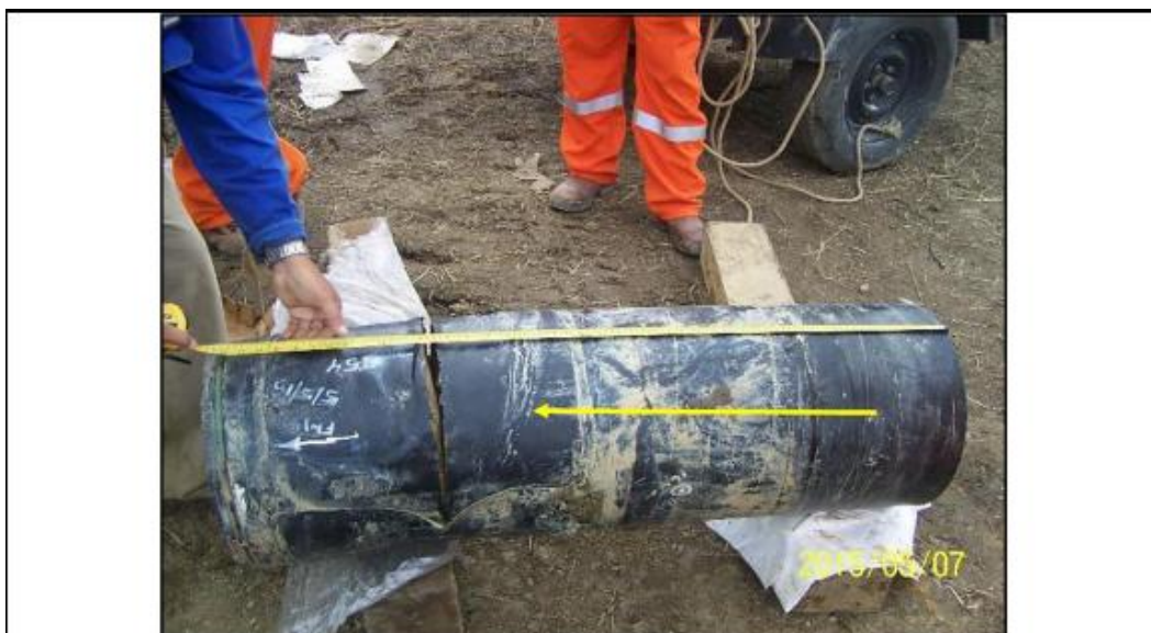
Imagen 18: Probeta que contiene la falla de longitud de 1,53 metros. La línea amarilla indica el sentido del flujo cuando estaba en servicio. (04.05.2015)
