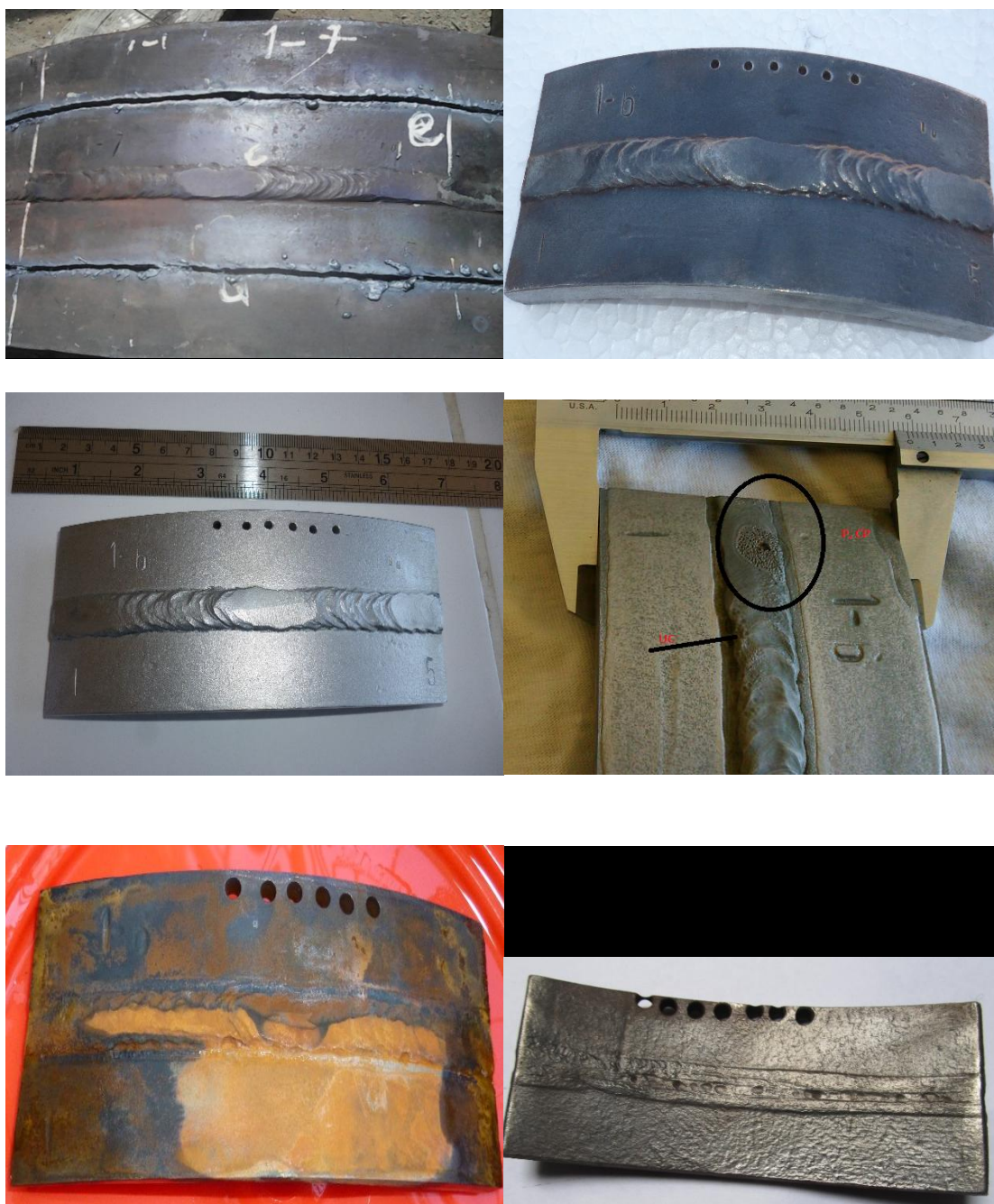
Figuras I.1. Se observa, la inspección visual realizada inicialmente a la muestra e identificación de la muestra, e inspecciones durante el ataque con agua regia, mostrando el inicio de indicaciones, hasta el rechazo, aplicado el criterio de aceptación/rechazo del API 1104.
