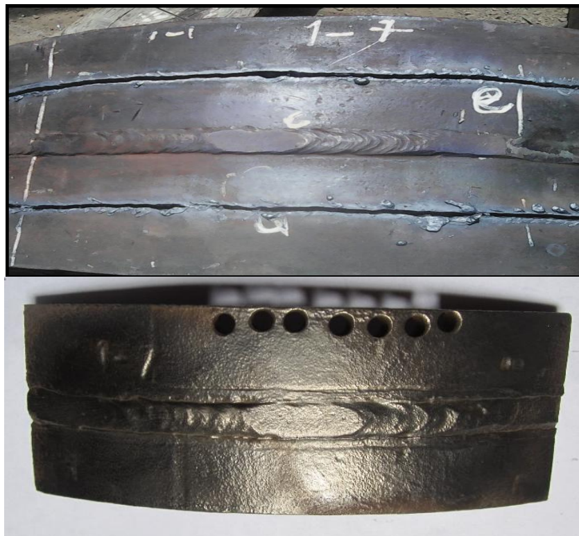
Figura 4.12. Evolución de la muestra antes y después del ataque con agua regia
