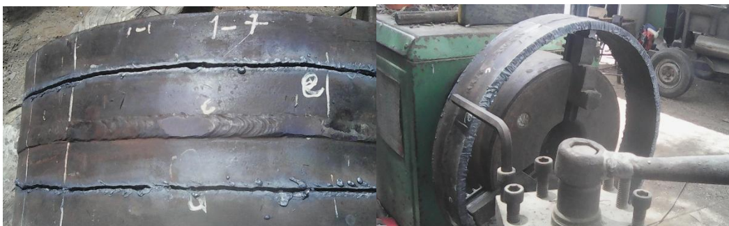
Figura 4.1. Reducción de tamaño de la muestra de unión soldada
