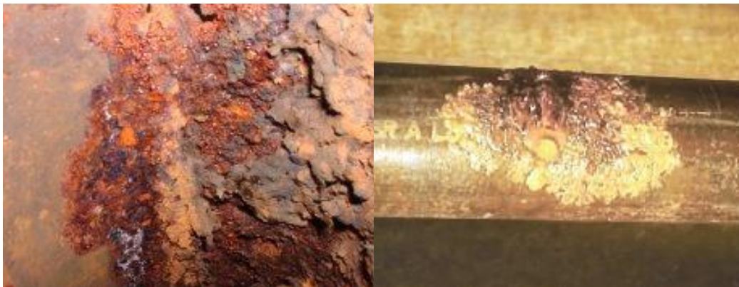
Figura 2.13. Corrosión microbiológica (Carrasco, 2008)
