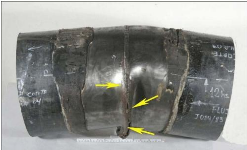
FOTO N° 06: Junta 084/83, vista del Vista de la parte superior de la tubería pandeada, indicado por la marca 12 h. La dirección del flujo se indica de derecha a izquierda. Las flechas indican las grietas en el dobléz. (Fuente: Informe Laboratorio de Stork)
