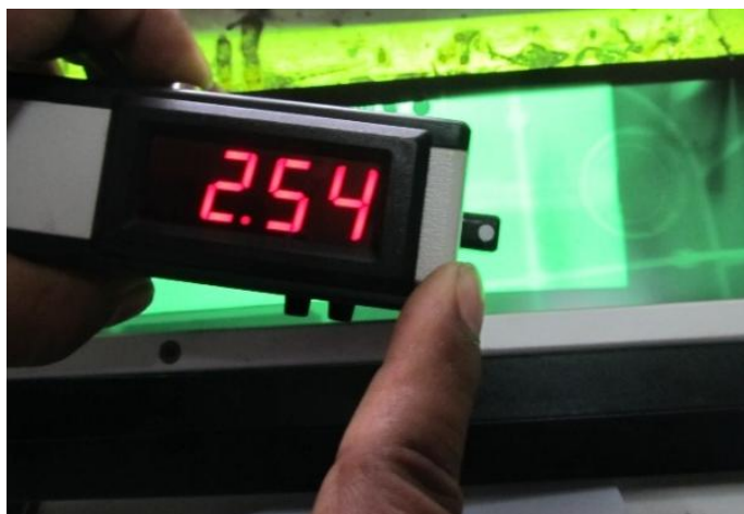
Fig. 4.14. Verificación de la densidad del film radiográfico
