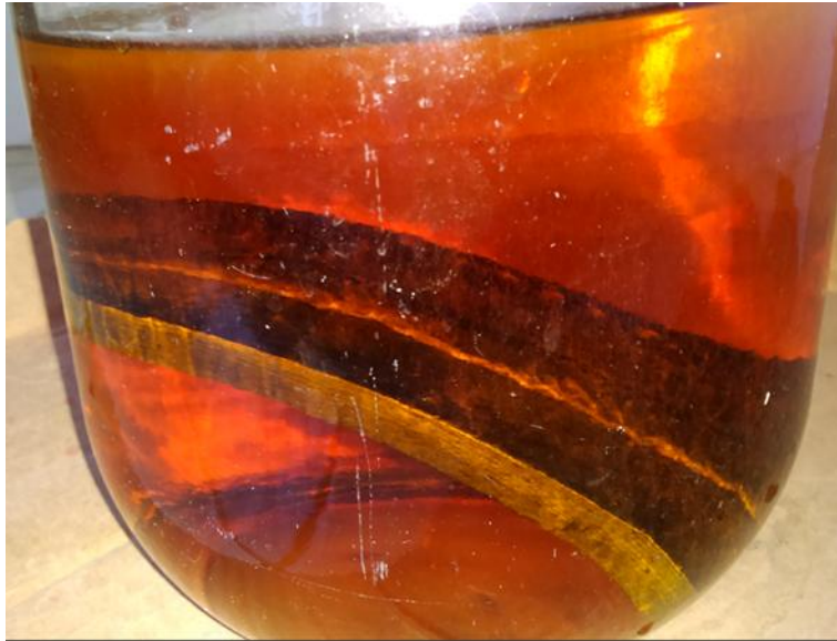
Figura 4.7. Inmersión de la muestra en agua regia
