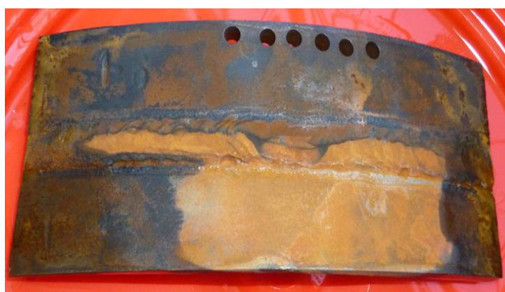
Fig. 4.19. Grado de corrosión alcanzado, Grado B; la cual se elimina con la limpieza, SSPC-SP-3
