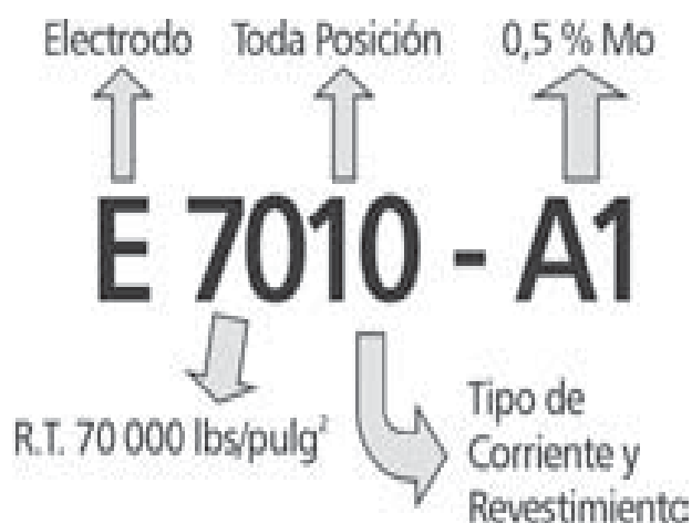
Figura 2.1. Interpretación de la norma para la identificación de los electrodos (Oerlikon – Exsa, 1999, p. 47)
