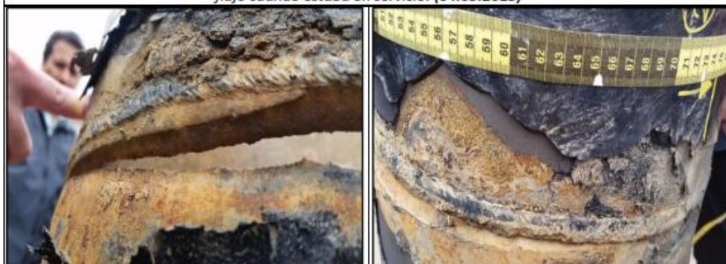
Imagen 19: Vista de la rotura que está próxima a la soldadura.
