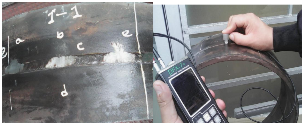
Figura 4.15. Ubicación inicial de los puntos, y medición de espesores iniciales.
