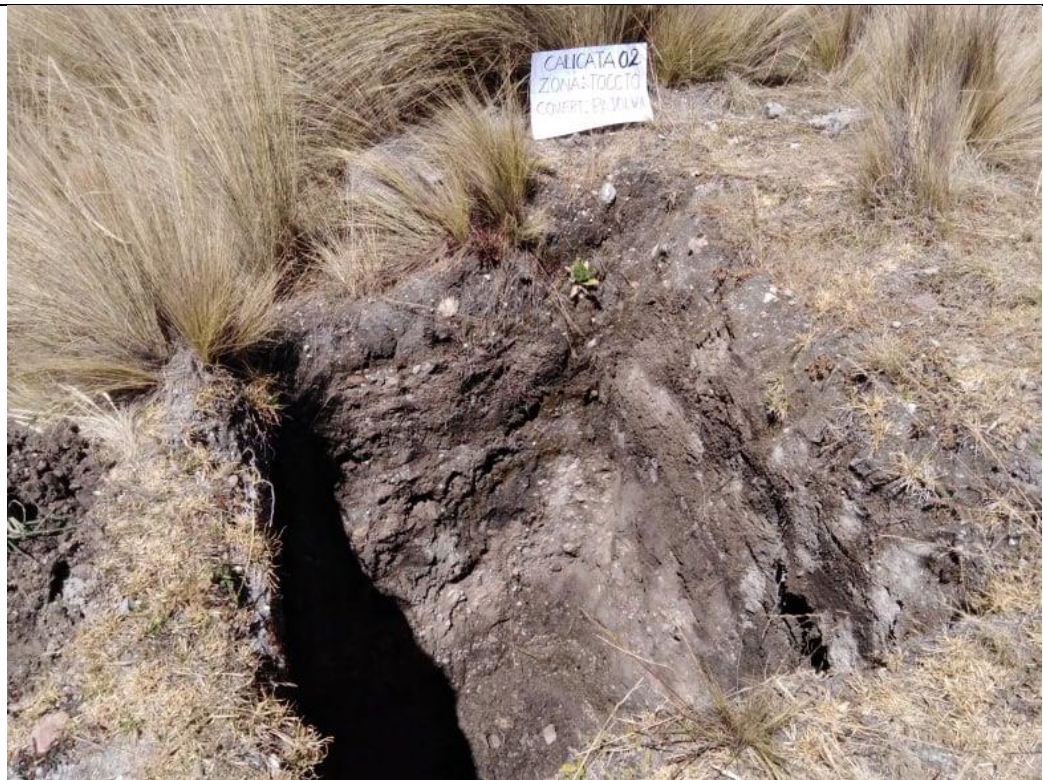
Figura 2.6. Calicata del suelo en área cubierta por pajonal
