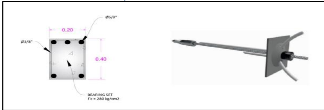
Ilustración 12: Pernos de anclaje
