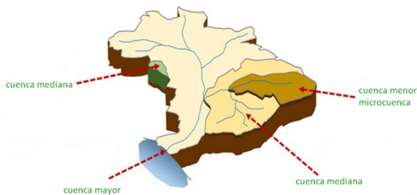
Figura 2.2: Clasificación de cuencas hidrográficas según su tamaño
