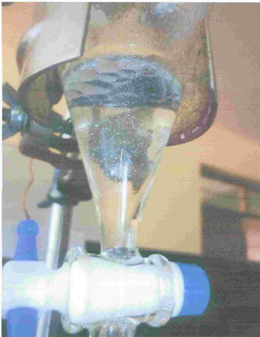
Fotografía N° 03. Separación del aceite esencial del agua en una para de separacion de vidrio en el area de Farmacognosia. UNSCH. Ayacucho, 2011.
