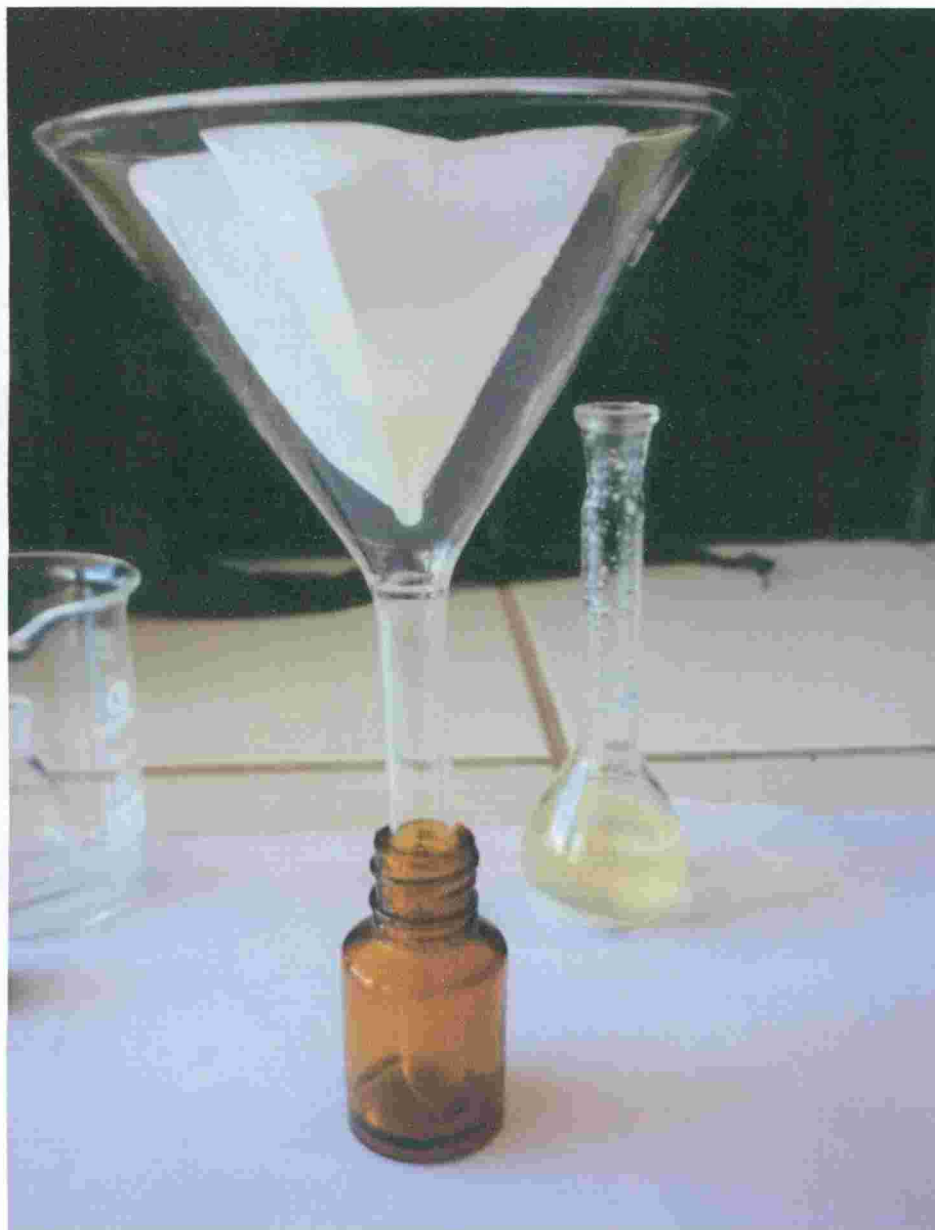
Fotografía N° 04. Obtención de aceite esencial puro quitando los residuos de agua con sulfato de sodio anhidro en el área de Farmacognosia. UNSCH. Ayacucho, 2011.
