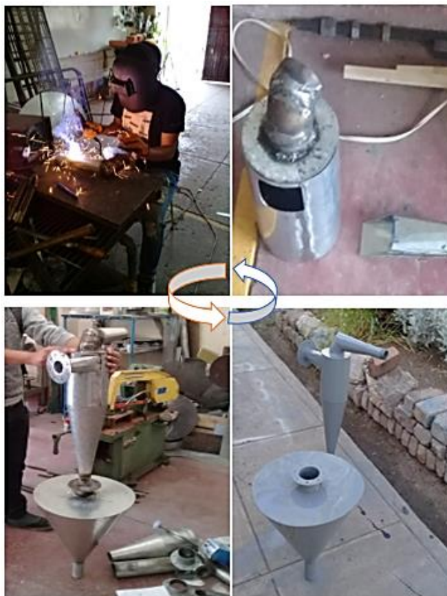
Figura 29. Construcción del hidrociclón
