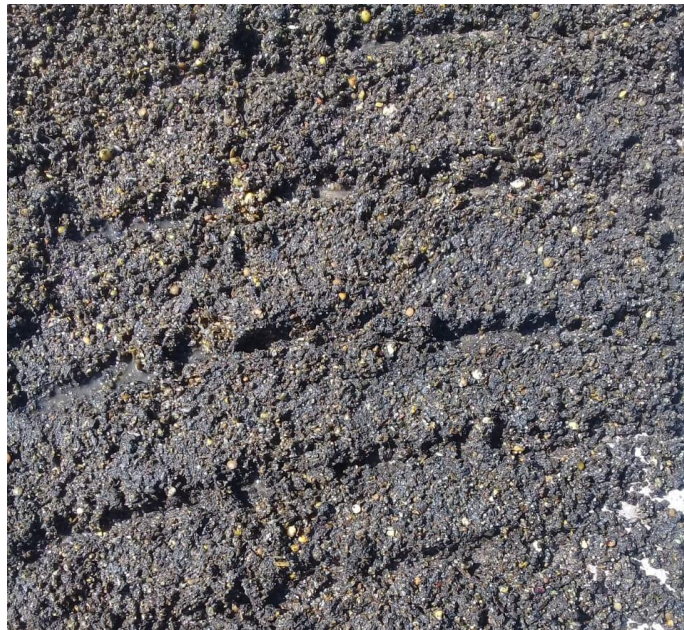
Figura 6.2. El secado de sólidos en el lecho se hizo con fines de ser pesado para saber qué cantidad se ha retirado en dicha evaluación.
