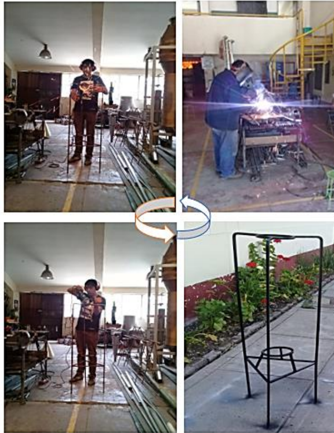
Figura 30. Construcción del módulo para el soporte del hidrociclón
