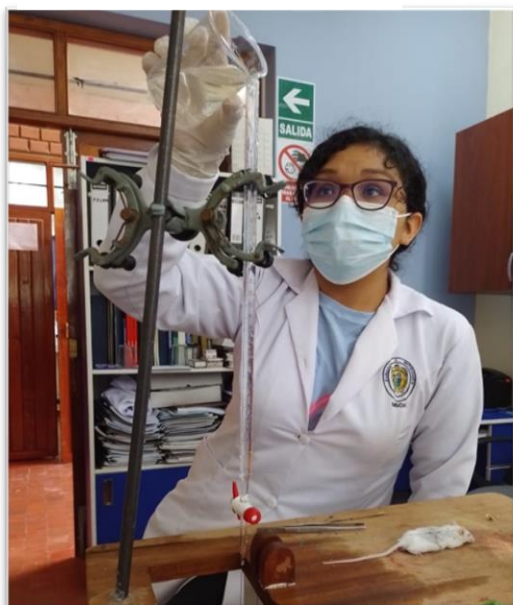
Realizando el método de medida de la fuerza de tensión ejercida y necesaria para abrir una herida incisa.
