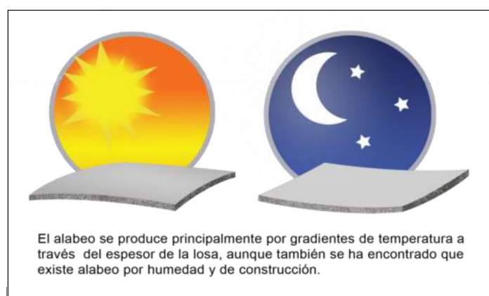
Figura 3.6: Alabeo debido al efecto de la temperatura
