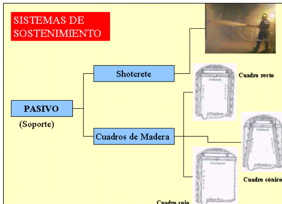
Figura 33. Esquema de sostenimiento.
