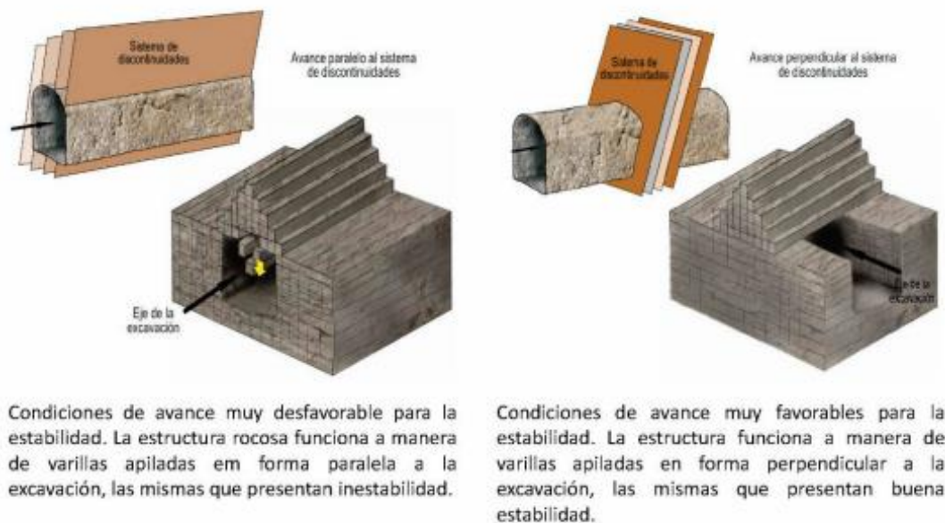
Figura 5. Orientación de la excavación con respecto a los rasgos estructurales.
