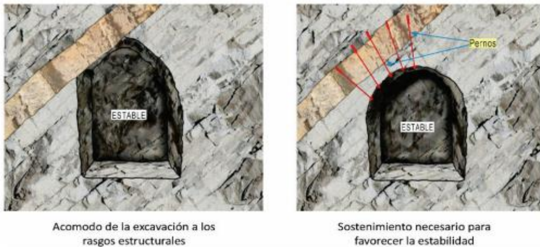
Figura 4. Formas de las excavaciones.
