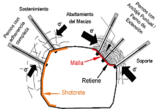
Figura 14. Capacidad de la malla metálica para retener rocas sueltas entre pernos.
