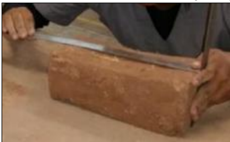
Figura 49. Toma de medidas de los adobes con mucílago de nopal.
