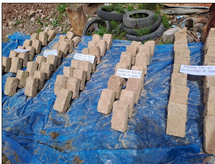
Figura 47. Almacenamiento de los adobes para su secado
