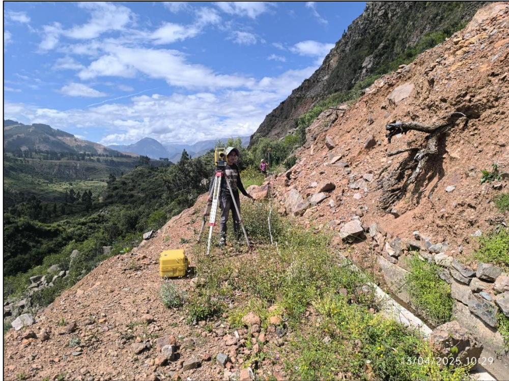
Imagen 15: Levantamiento topográfico para la viabilidad de una alternativa de inversión pública – Tramo I (CDC a Reservorio)
