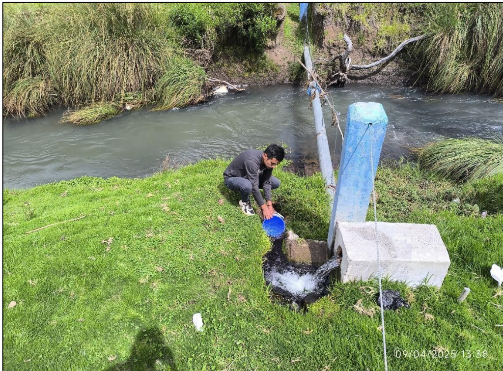
Imagen 6: Aforo del manante Tornopampa a la salida de captación
