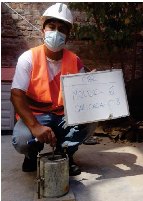
Figura 27 Vista fotográfica del ensayo de compactación C.B.R.
