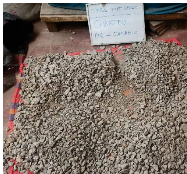
Figura 33 Cuarteo del concreto triturado.
