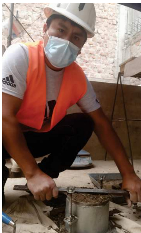
Figura 25 Procto Modificado - Enrasado.
