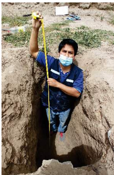
Figura 7 Vista fotográfica de la Calicata N° 01. Fuente: Elaboración propia
