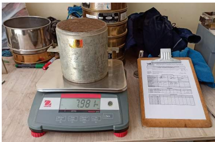
Figura 24 Pesado del molde + muestra del ensayo Procto Modificado. Fuente: Elaboración propia
