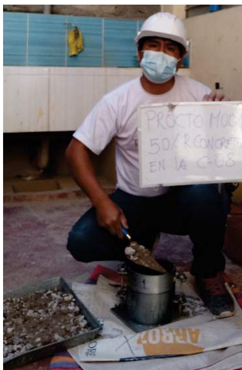
Figura 38 Ensayo Procto Modificado con 50% de concreto + 50% de Calicata N°8 Fuente: Elaboración propia
