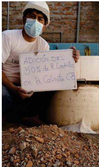
Figura 37 Mezcla del 50% de R. ladrillo y 50% de muestra de la Calicata N°8 Fuente: Elaboración propia
