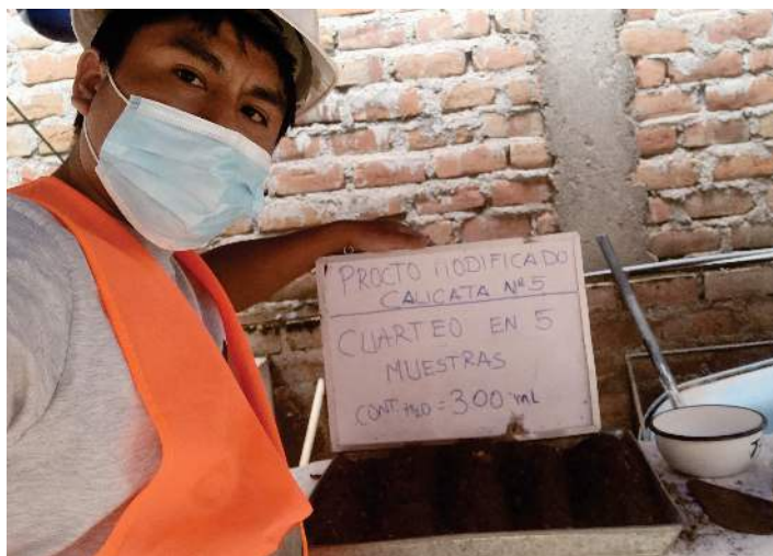
Figura 23 Cuarteo en 5 muestras para el ensayo Procto Modificado. Fuente: Elaboración propia
