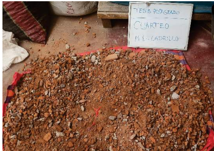
Figura 35 Cuarteo del ladrillo triturado. Fuente: Elaboración propia
