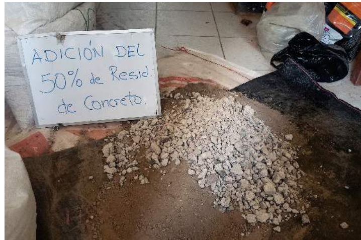
Figura 36 Mezcla del 50% de R. concreto y 50% de muestra de la Calicata N°8. Fuente: Elaboración propia
