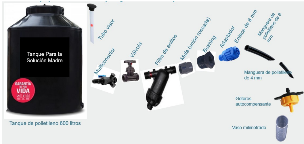
Figura 7. Partes del sistema de cloración por goteo autocompensante: tanque de solución madre y componentes de salida.
