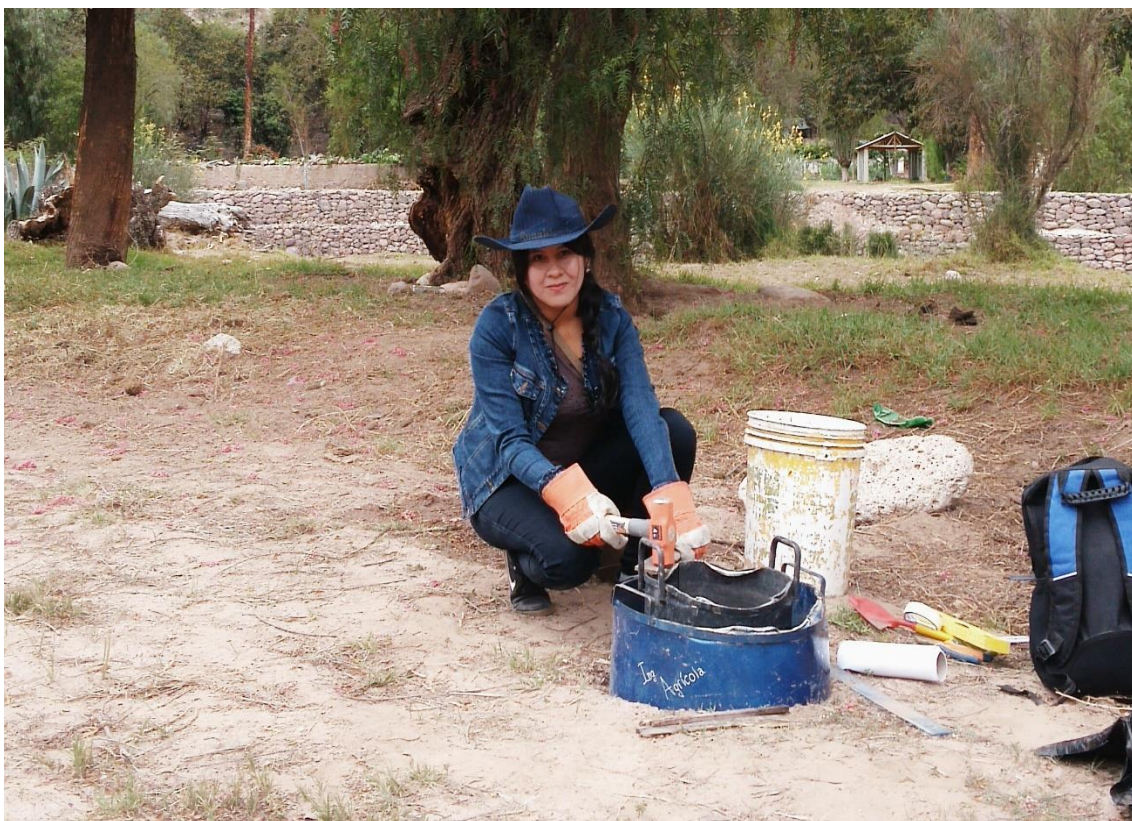
Foto 17. Instalación de los Anillos concéntricos
