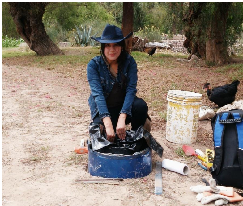
Foto 19. Cubriendo con plástico antes del llenado de agua para evitar la errores en los cálculos de la prueba de infiltración y ubicada la regla graduada
