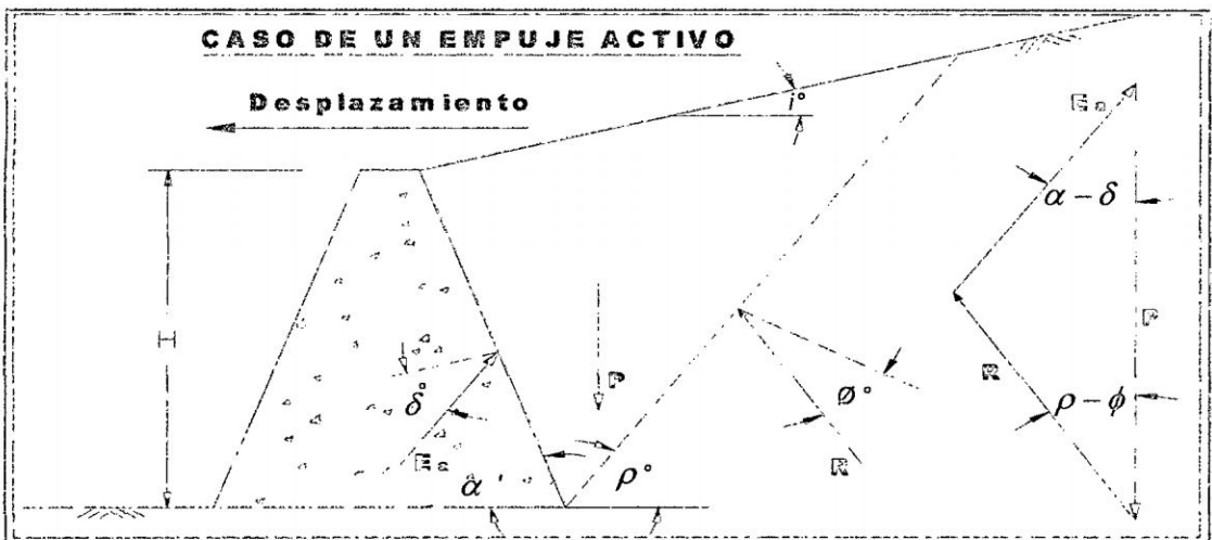
Fig. 4.12 Fuerzas que actúan sobre la cuña de suelo en el caso activo.
