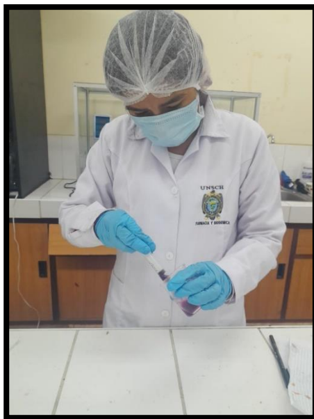
c) Mezclar y disolver el aloxano con agua.
