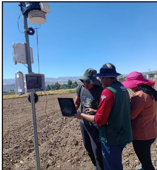
Fotografía 10. Descarga de datos de la estación meteorológica Vatange pro2 Plus
