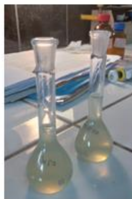
Muestra de hojas y tallos de elodea preparado con los reactivos para la determinación del contenido de fenoles y posterior lectura en el espectrofotómetro
