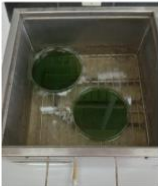
Disposición del filtrado de la "elodea" en placas de Petri para llevarlos a baño maría a 40°C para la evaporación del alcohol
