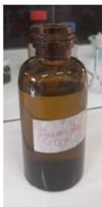
Estándar quercetina para la curva espectral y de calibración de flavonoides
