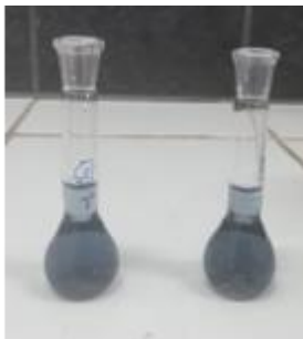
Preparación de la muestra de tallos y hojas para la lectura de absorbancia y determinación del contenido de proteínas
