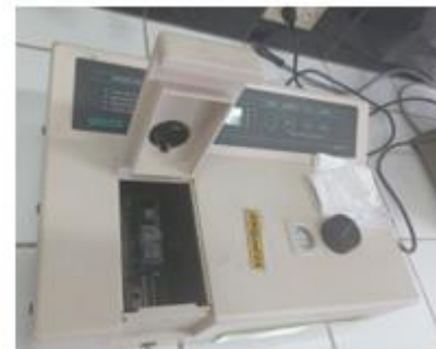
Espectrofotómetro para la lectura de absorbancia para la curva espectral y de calibración
