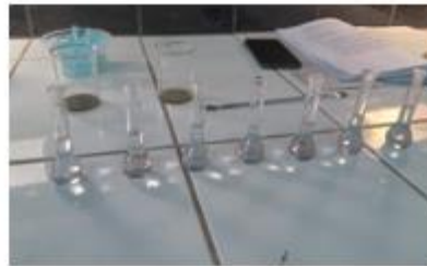
Preparación de reactivos a diferentes concentraciones para realizar la curva espectral y de calibración para fenoles
