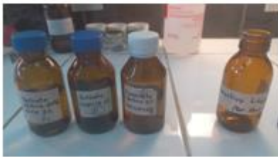
Tartrato sódico-potásico 2%, sulfato cúprico 1% y carbonato sódico 2% para preparar el reactivo de Lowry
