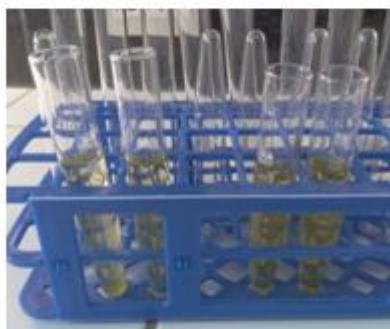
Muestra de hojas y tallos de "elodea" preparado con los reactivos para la determinación del contenido de flavonoides y posterior lectura en el espectrofotómetro
