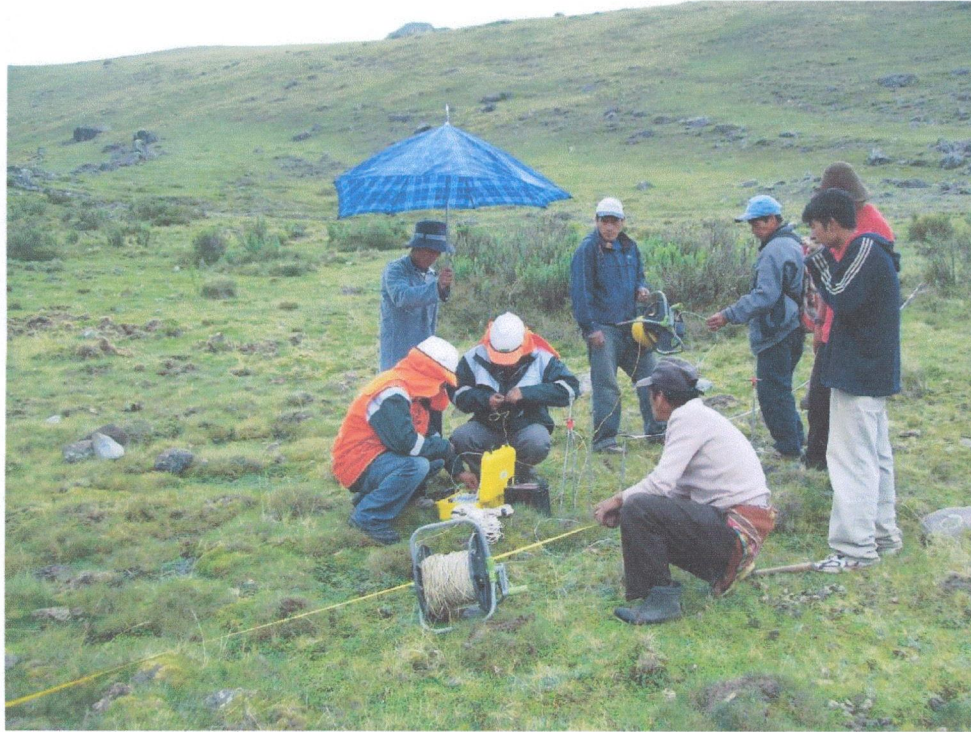
Foto 03.- Instalación del Equipo de Resistividad
