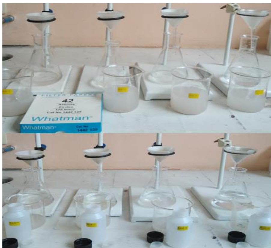
Foto 13: FILTRADO DE LAS CENIZAS VOLANTES MODIFICADAS LUEGO DE LA REMOCIÓN DE IONES Ni (II) Pb (II)
