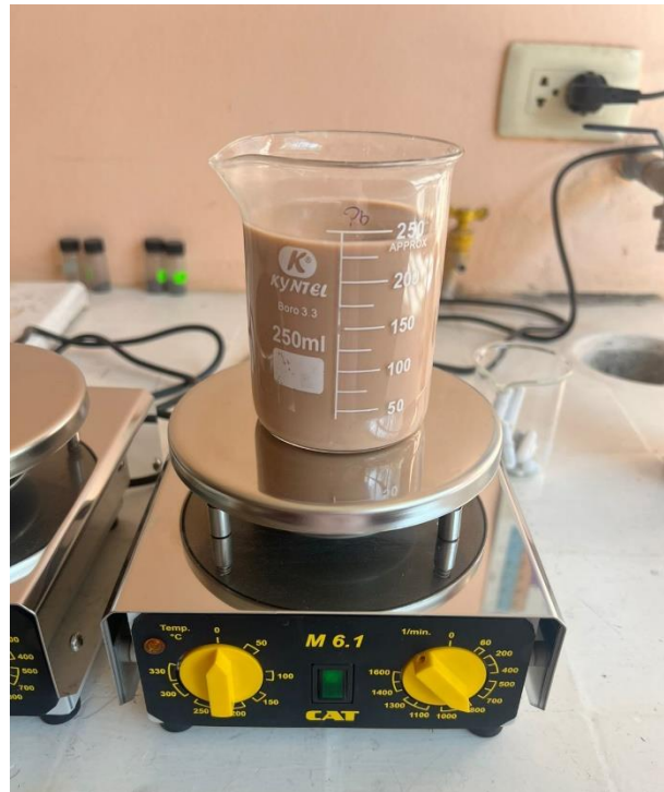
Foto 10: LAVADO DE LAS CENIZAS VOLANTES
