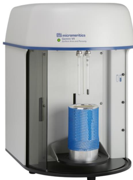
FOTO 2: EQUIPO BET-MICROMERITICS GEMINI-VII 2390 SERIE T
