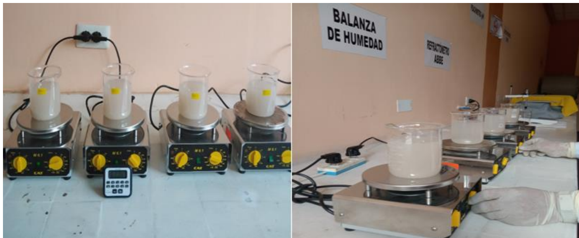
Foto 12: PROCESO DE LA RETENCIÓN DE Ni (II) y Pb (II)
