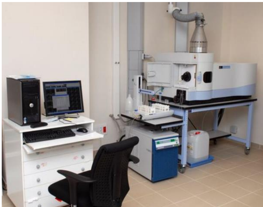
FOTO 3: ESPECTROSCOPIA DE PLASMA ICP-OES TECNOLOGÍA DUAL VIEW CON VISIÓN RADIAL Y AXIAL
