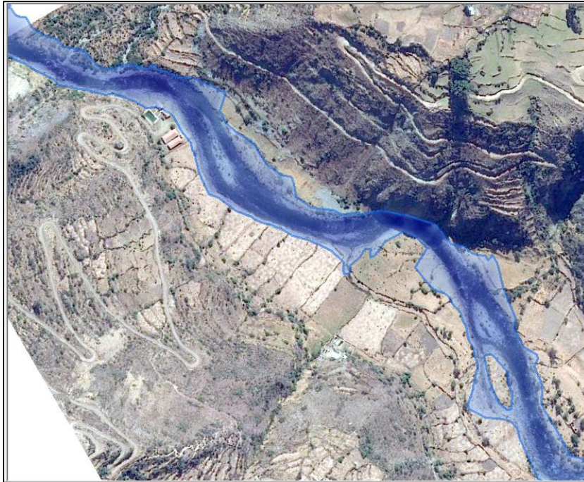
Figura 2.115: Finalización de la elaboración de planicies de inundación con fondo de una orthoimagen.
