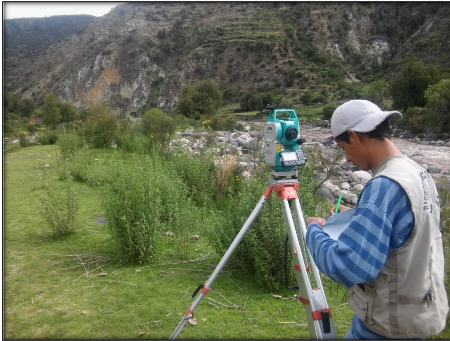
Foto 11: Levantamiento topográfico del cauce del tramo baños termales de Larcay, con estación total
