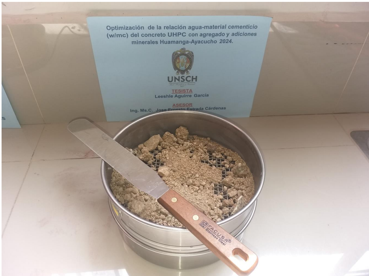
Figura 21: Tamizado del agregado con malla 3/8".
