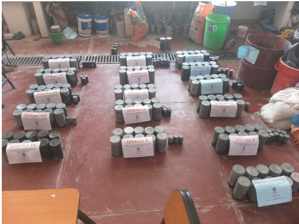
Foto 28. Probetas de 5 cm de diámetro y 10 cm de altura, con fines de verificación y rotura a los 7, 14 y 21 días.
