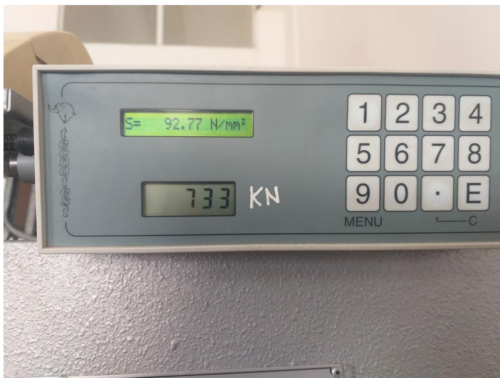
Foto 44. Resultado de rotura del ensayo a la compresión en probetas realizadas.
