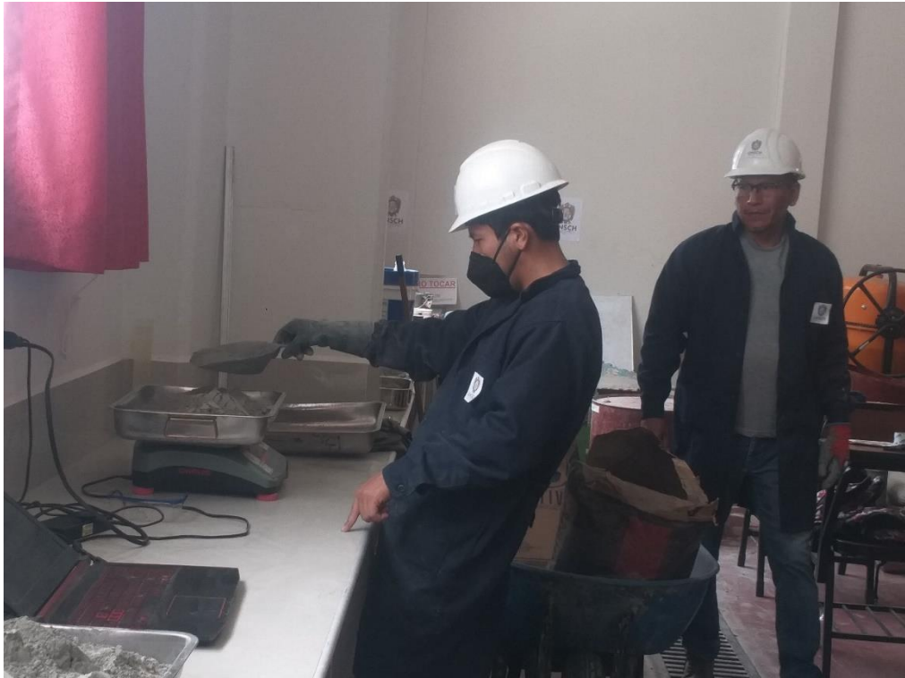
Foto 3. Pesado del cemento portland tipo I de acuerdo al diseño de mezcla propuesto.
