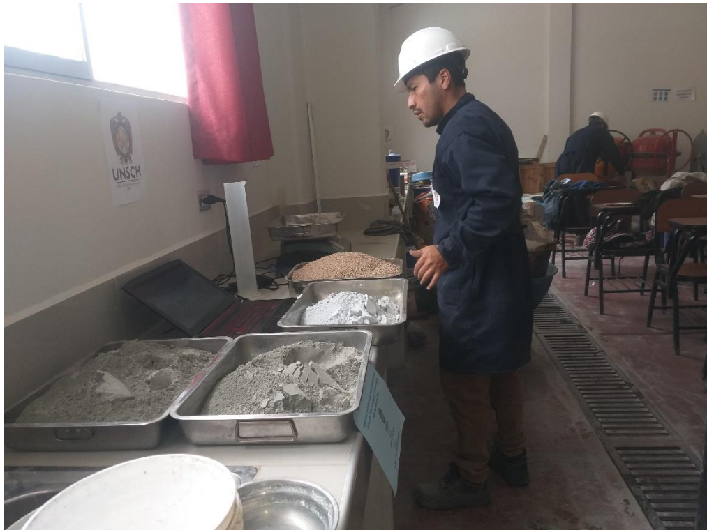
Foto 7. Materiales pesados y listos para la mezcla y preparación del concreto UHPC.
