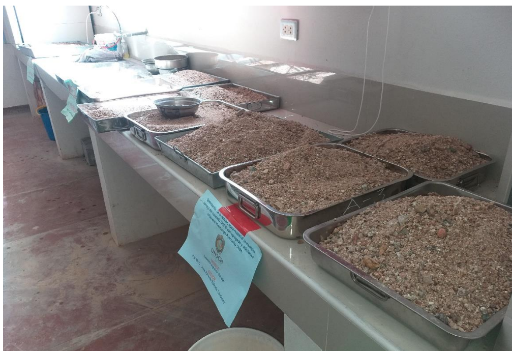
Foto 2. Proceso de lavado y selección de agregado fino de la cantera la cazadora, Huayhuacondo, Distrito d Tambillo, Huamanga, Ayacucho.
