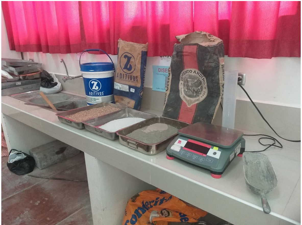
Figura 22: Materiales listos para la preparación del concreto UHPC.
