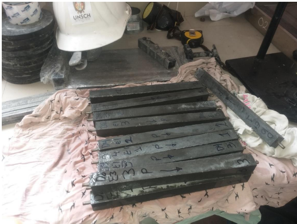
Foto 19. Primas de concreto UHPC, listas para la medición.
