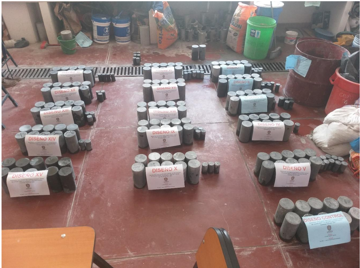
Figura 30: Probetas con los 15 diseños de mezcla más el diseño en referencia y/o control.
