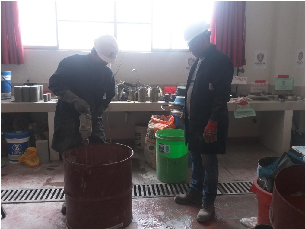
Foto 10. Mezcla del concreto UHPC, etapa en la cual se observa las esferas antes de la conformación de la mezcla final.
