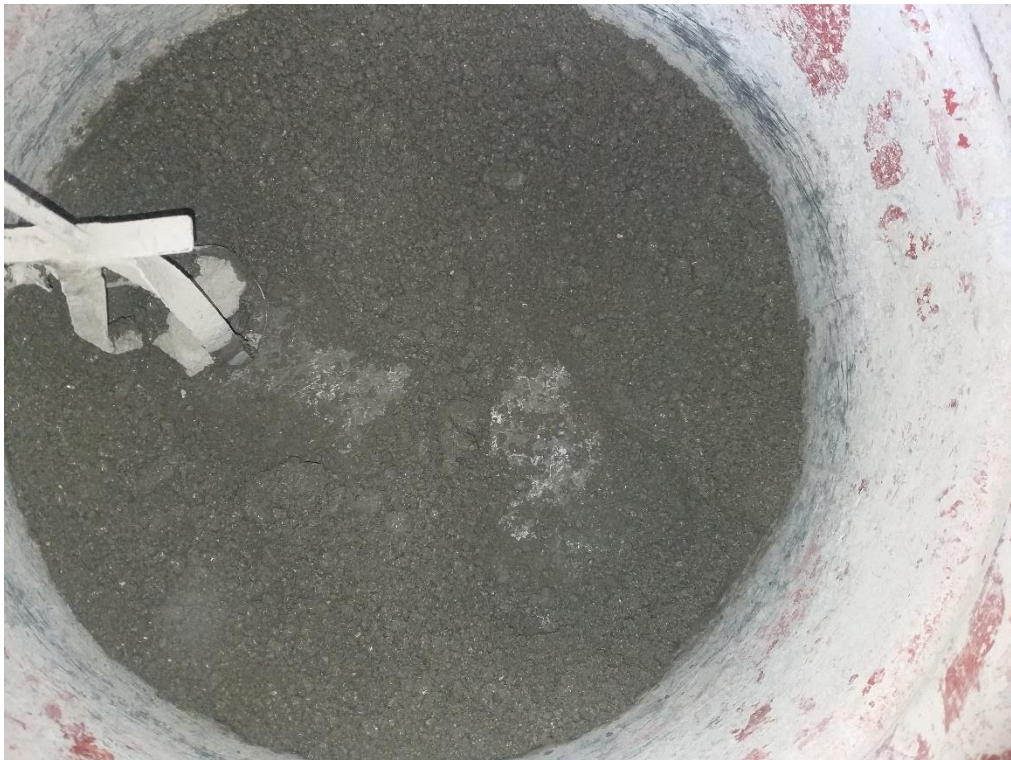
Foto 10. Mezcla del concreto UHPC, etapa en la cual se observa las esferas antes de la conformación de la mezcla final.
