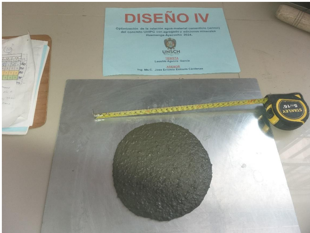
Foto 16. Ensayo de flujo, después de 2 minutos +/- 5 segundos .
