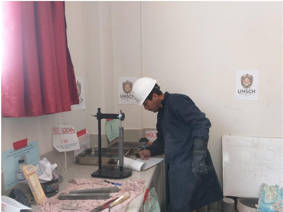
Figura 36: Medición de la longitud en primas, toma de datos en deformación.
