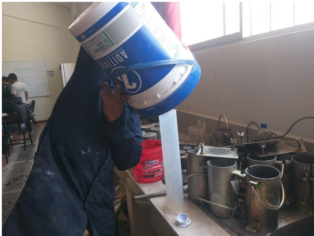
Foto 6. Disposición y pesado de aditivo superplastificante.
