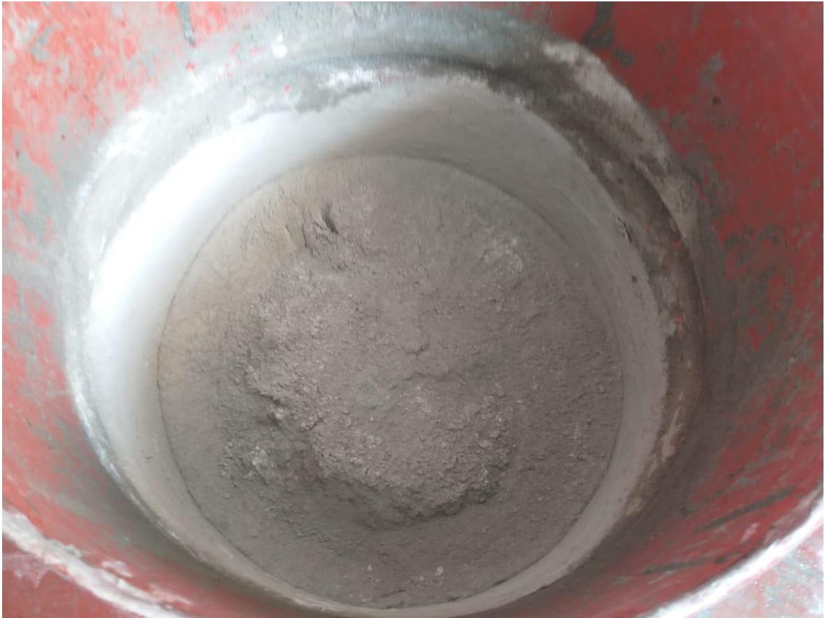
Figura 23: Mezclado en seco de los componentes como: Cemento portland, Humo de sílice y agregado fino.
