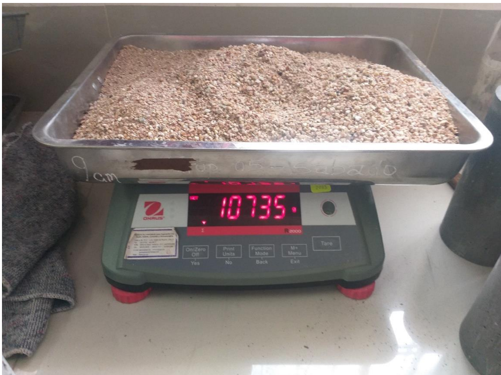
Foto 4. Pesado de agregado de acuerdo al diseño de mezcla propuesto.
