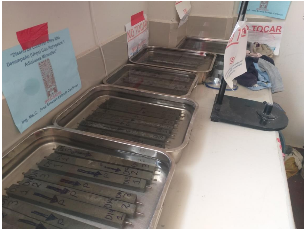
Foto 35. Prismas de concreto UHPC, evaluación de durabilidad los 16 diseños.
