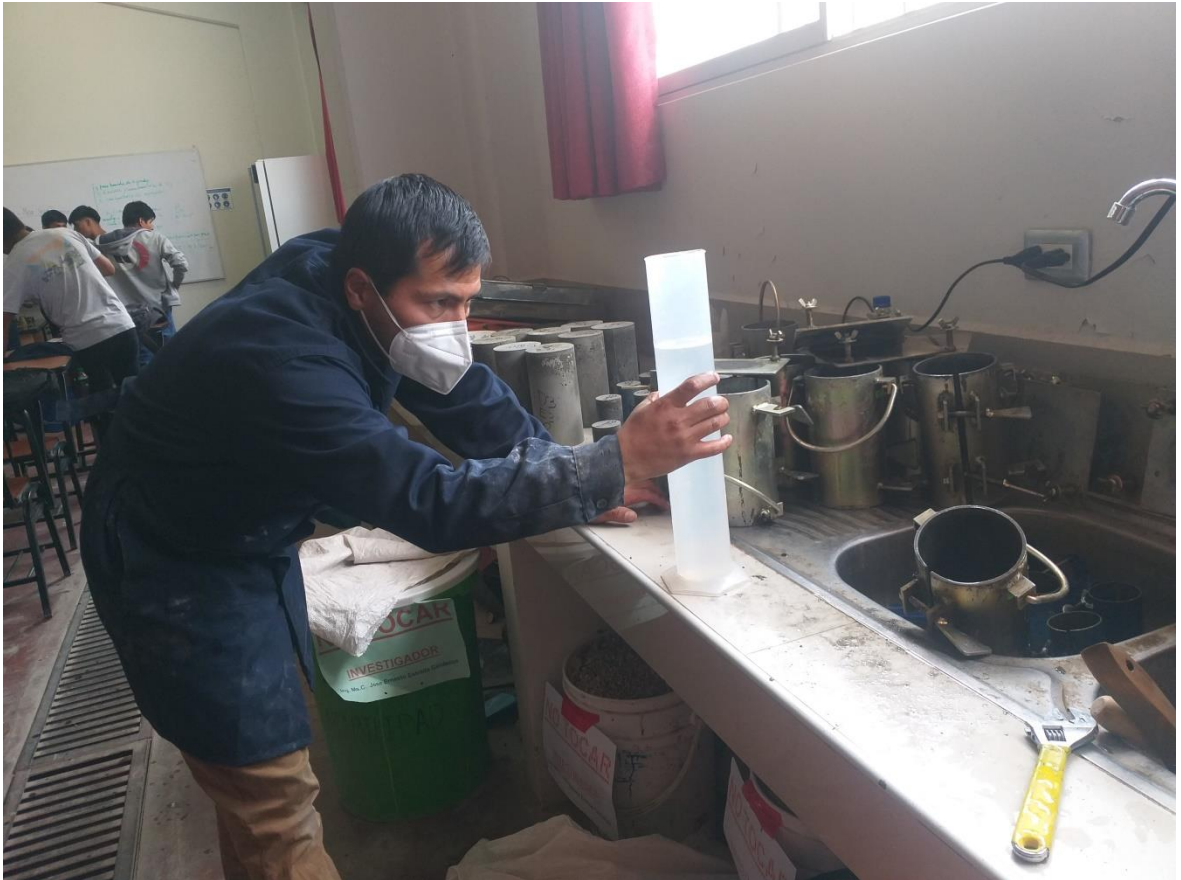
Figura 24: Mezcla de los componentes como: agua y superplastificante.
