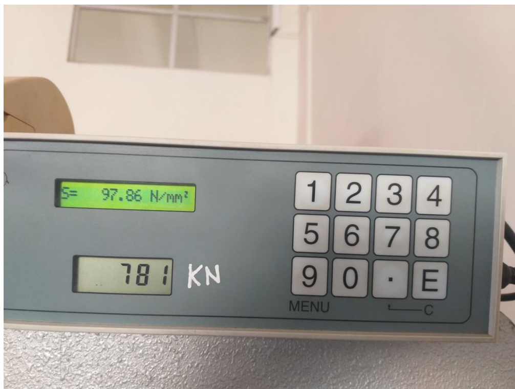
Foto 43. Resultado de rotura del ensayo a la compresión en probetas realizadas.
