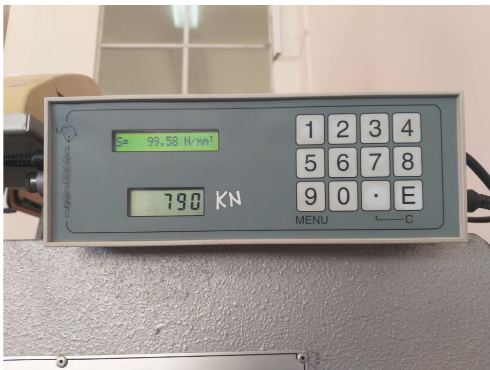
Foto 42. Resultado de rotura del ensayo a la compresión en probetas realizadas.
