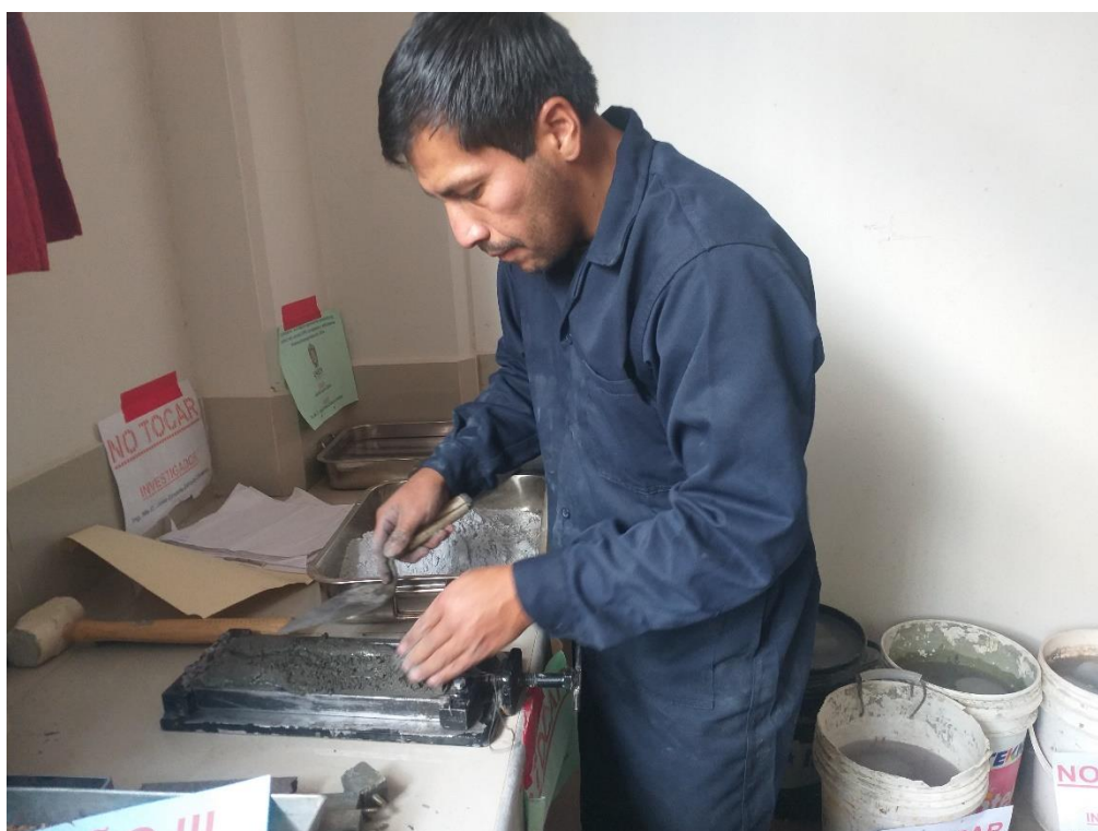
Foto 18. Colocación de concreto UHPC, para la preparación de primas del ensayo de Durabilidad.
