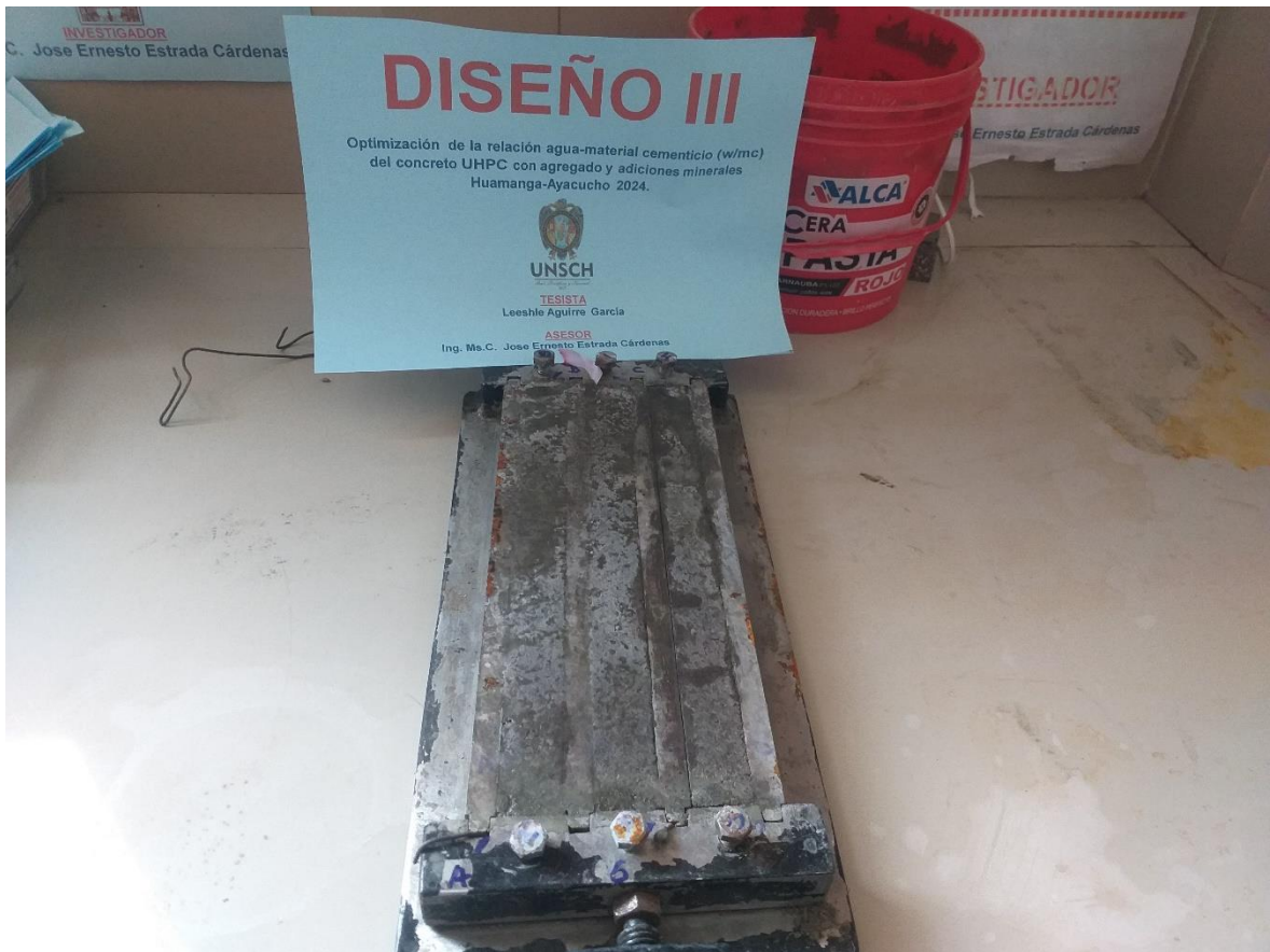
Figura 33: Colocación de concreto UHPC, para la preparación de primas del ensayo de Durabilidad.
