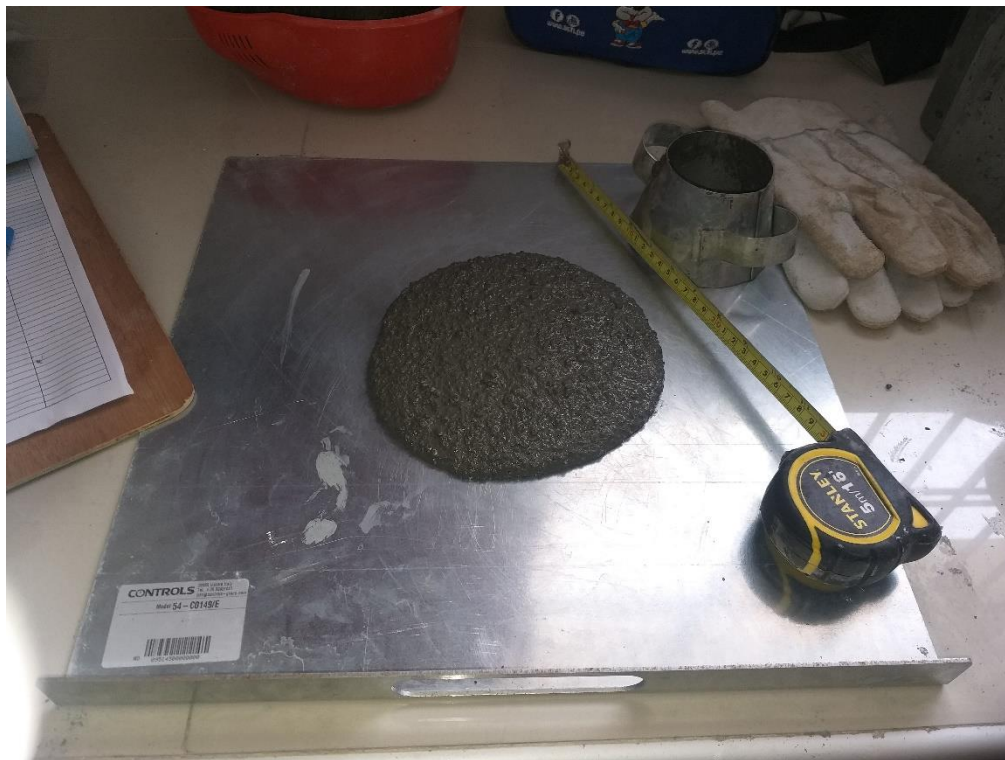
Foto 17. Ensayo de flujo, después de 2 minutos +/- 5 segundos.
