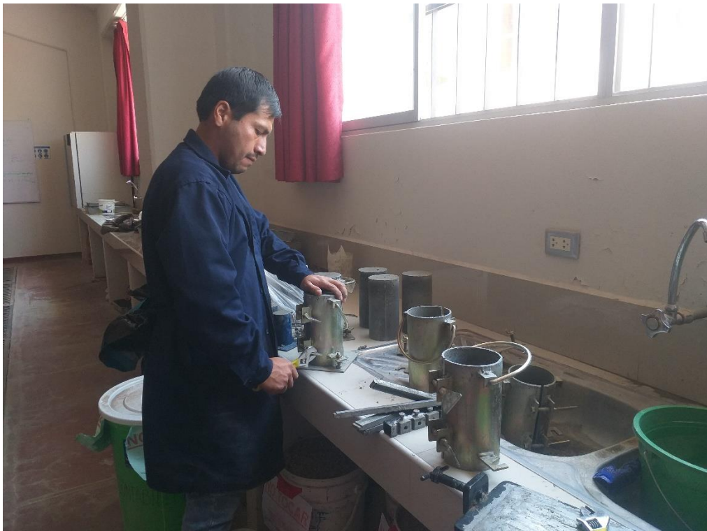
Foto12. Proceso de desmolde de probetas de concreto UHPC.
