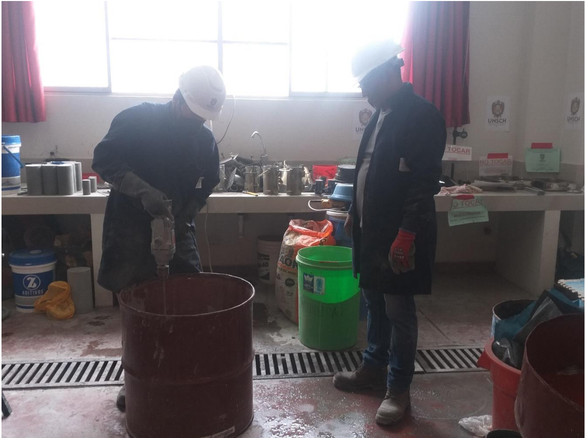
Figura 27: Mezcla de componentes con batidora manual del concreto UHPC.
