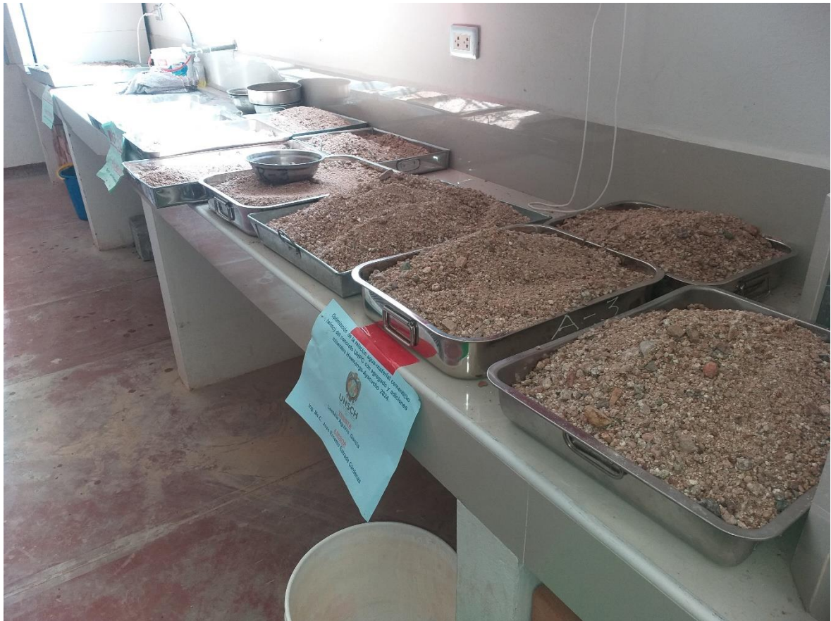
Figura 19: Proceso de lavado y selección de agregado fino de la cantera la cazadora, Huayhuacondo, Distrito de Tambillo, Huamanga, Ayacucho.
