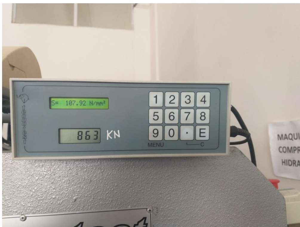
Foto 41. Resultado de rotura del ensayo a la compresión en probetas realizadas.
