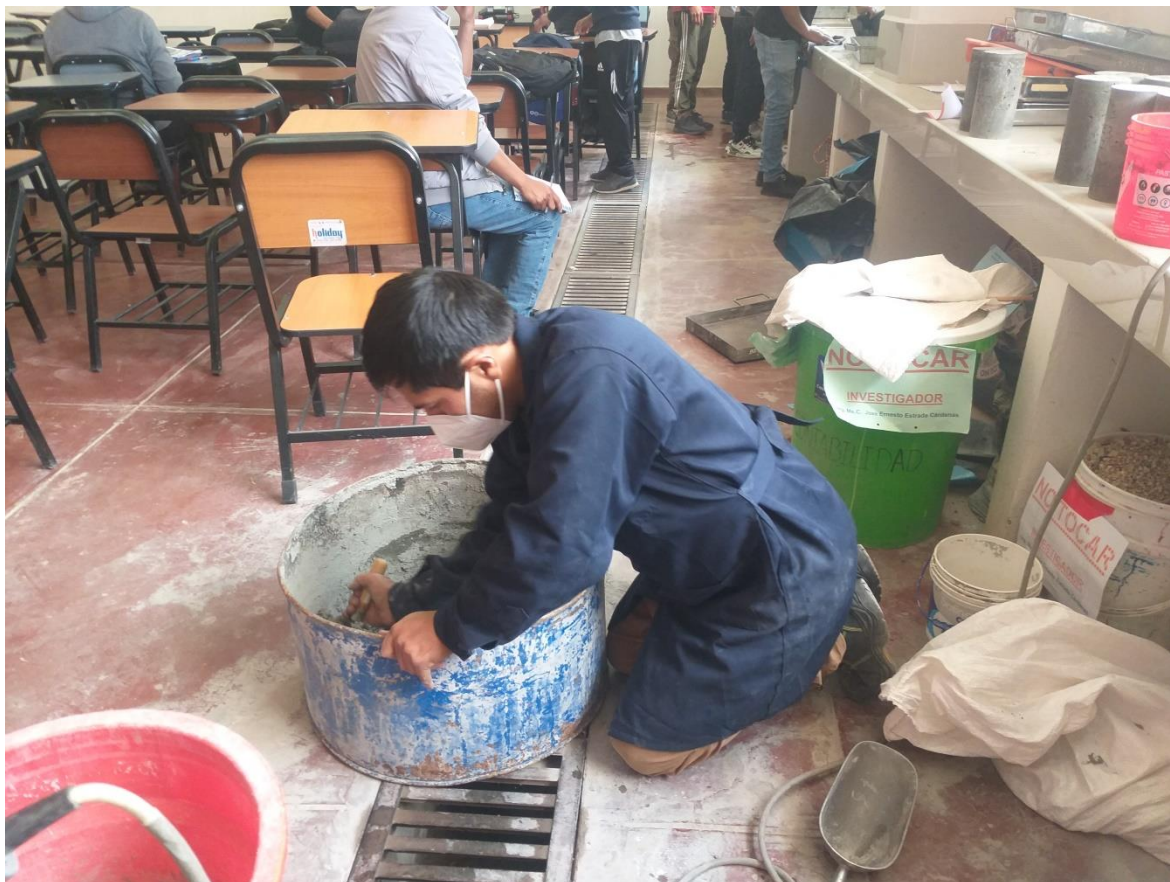
Figura 25: Mezcla de todos los componentes de forma manual del concreto UHPC.
