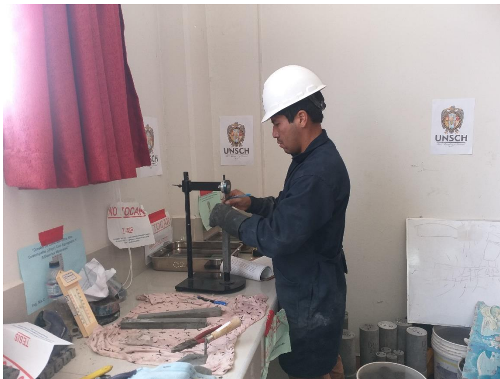
Foto 20. Medición de la longitud en primas, con fines de deformación.
