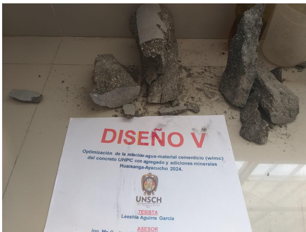
Foto 39. Probeta del diseño 5 rota y verificada en laboratorio.
