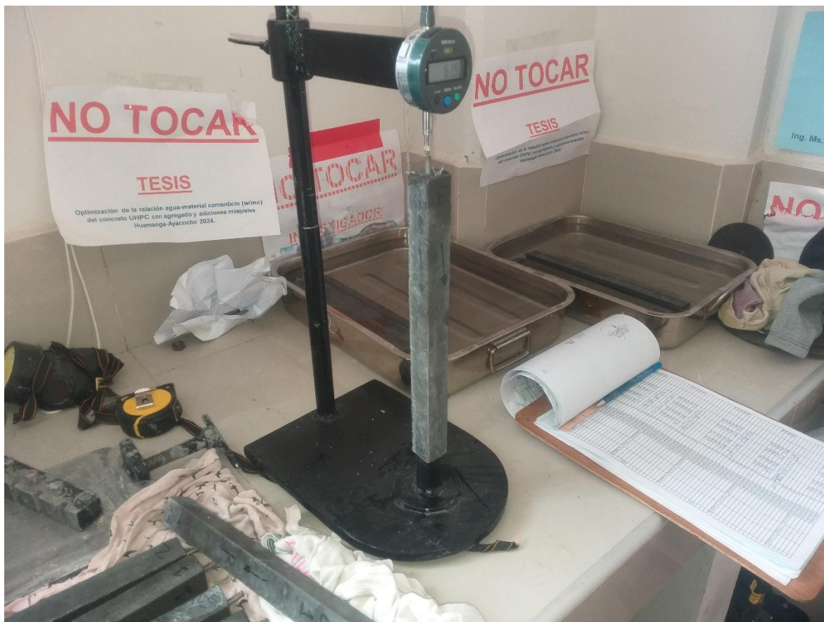
Figura 35: Toma de datos de la longitud en primas, con fines de deformación.
