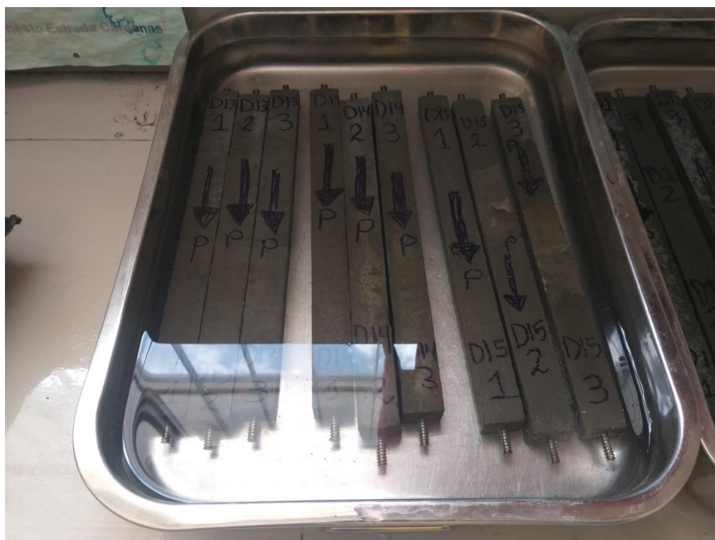
Foto 34. Prismas de concreto UHPC, evaluación de durabilidad, diseños 13, 14 y 15.
