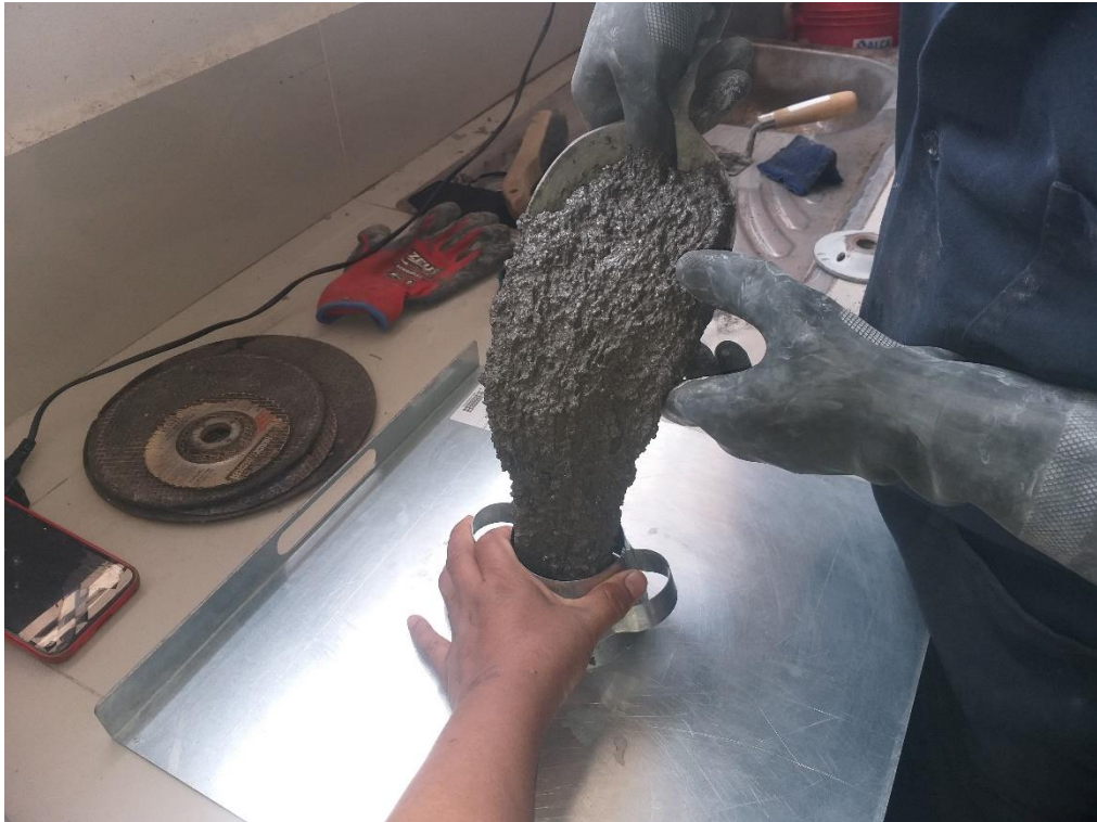
Foto 15. Colocación de concreto UHPC en el cono para el ensayo de flujo.
