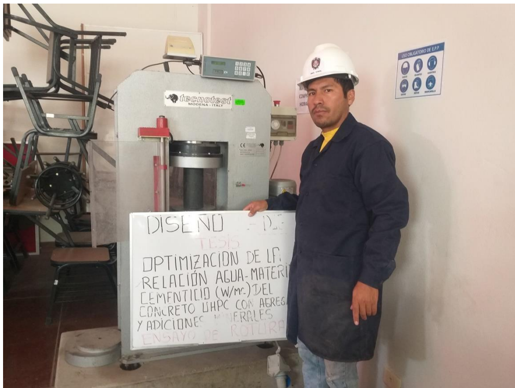
Foto 36. Roturas de probetas en máquina de compresión Tecnotest.
