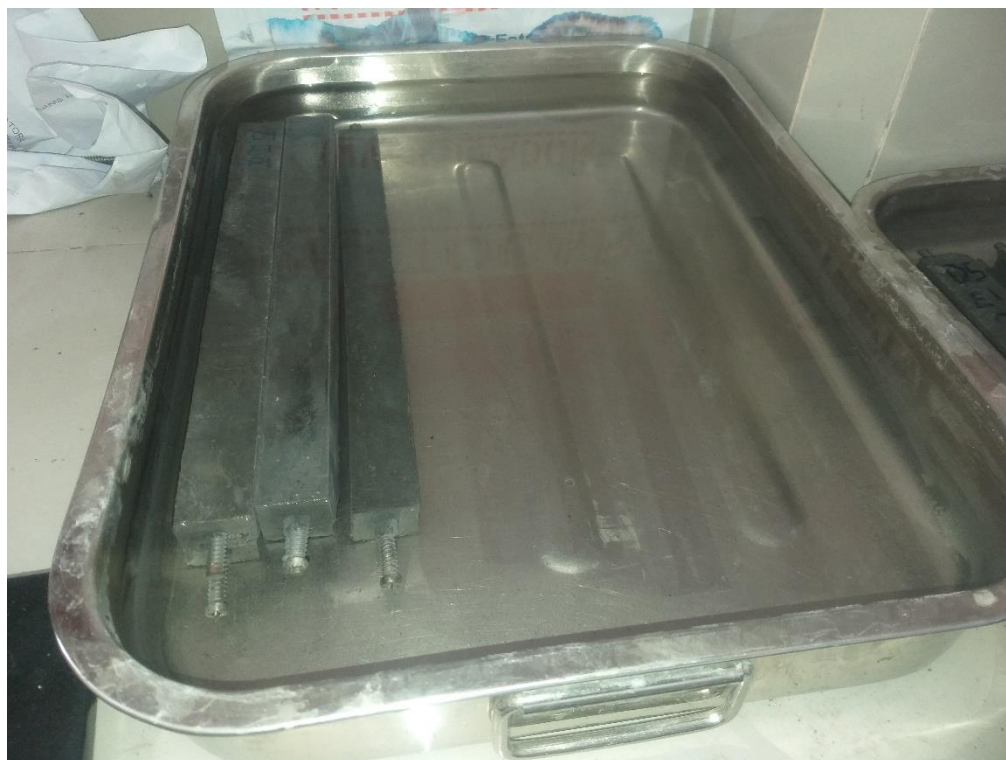
Foto 22. Curado de primas de concreto.
