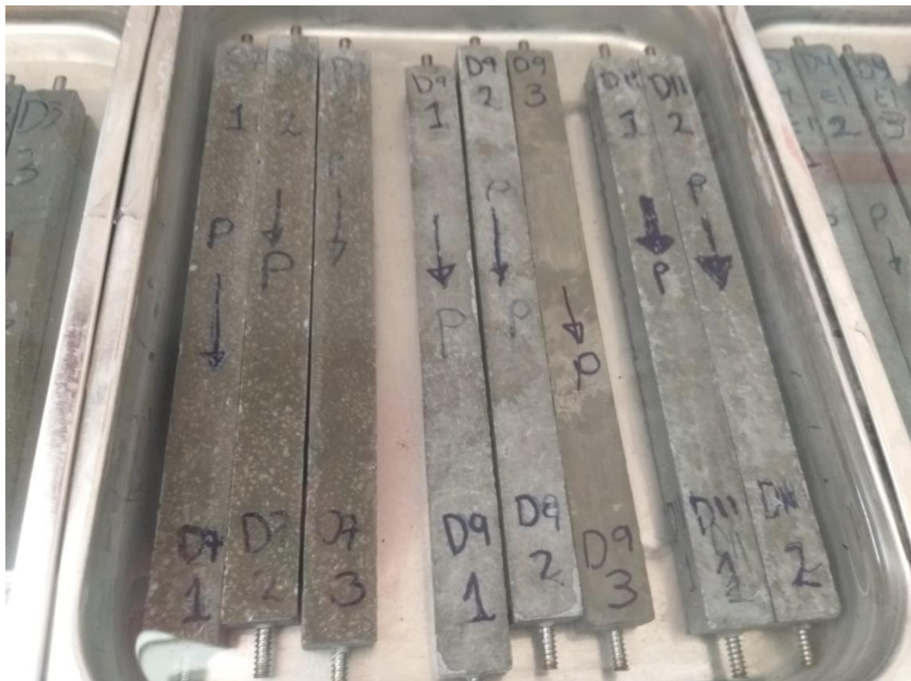
Foto 32. Prismas de concreto UHPC, evaluación de durabilidad diseños 7, 9 y 11.
