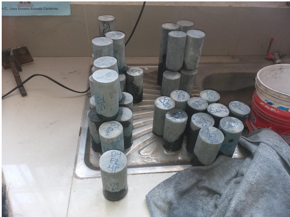
Foto 28. Probetas de 5 cm de diámetro y 10 cm de altura, con fines de verificación y rotura a los 7, 14 y 21 días.
