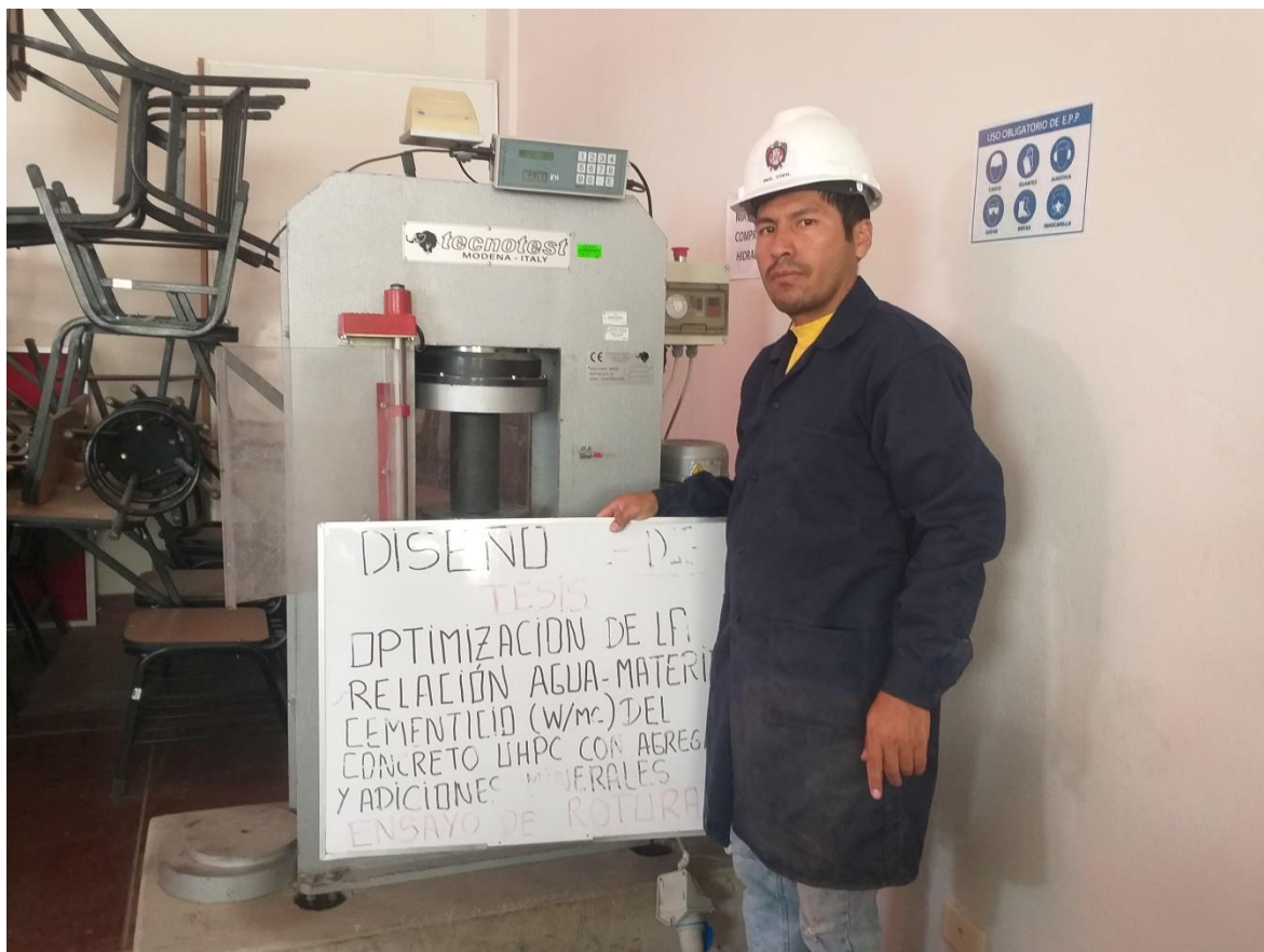
Figura 31: Ensayo de resistencia a la compresión, a probetas a los 28 días.
