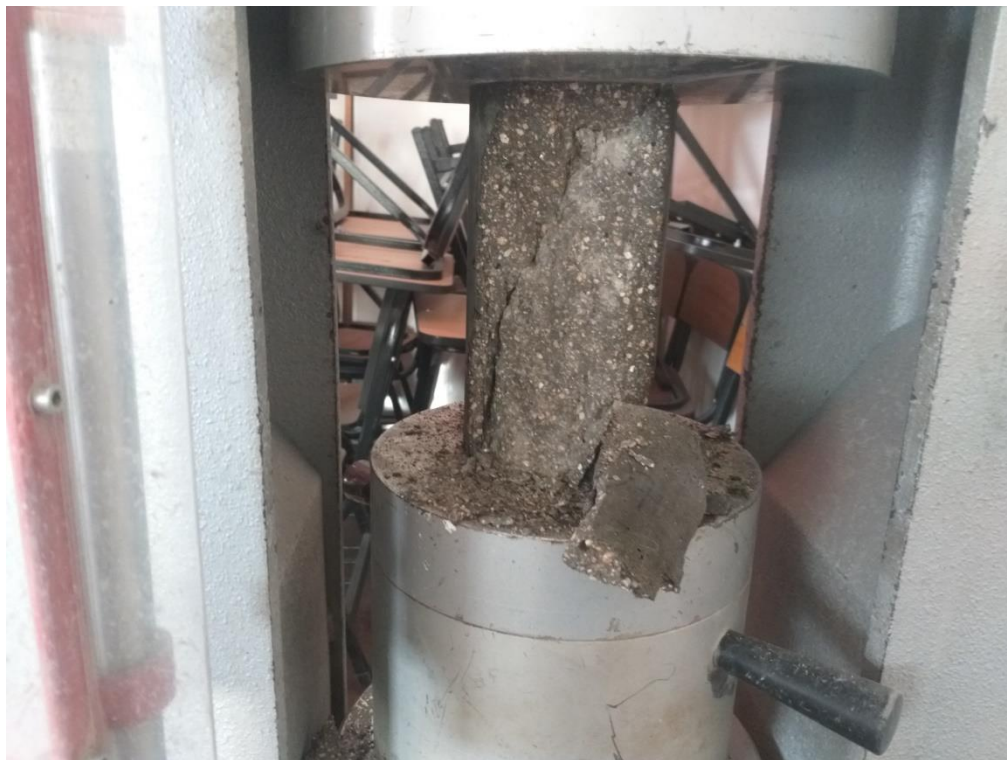
Foto 37. Muestra de probeta rota en máquina de compresión Tecnotest.
