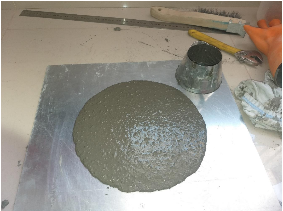
Figura 28: Ensayo de flujo, después de 2 minutos +/- 5 segundos.
