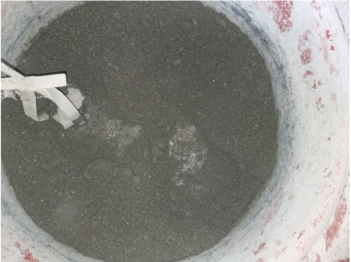
Figura 26: Mezcla del concreto UHPC, etapa en la cual se observa las esferas antes de la conformación de la mezcla final.
