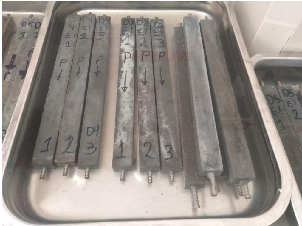
Foto 31. Prismas de concreto UHPC, evaluación de durabilidad, diseños 4, 8, referencia.
