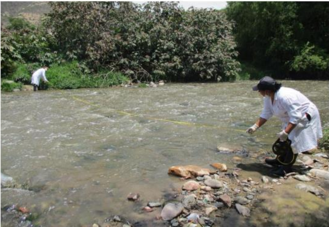
Toma de datos para medición del caudal en la estación de muestreo 4 (Rmuyu-04), en la época de lluvia
