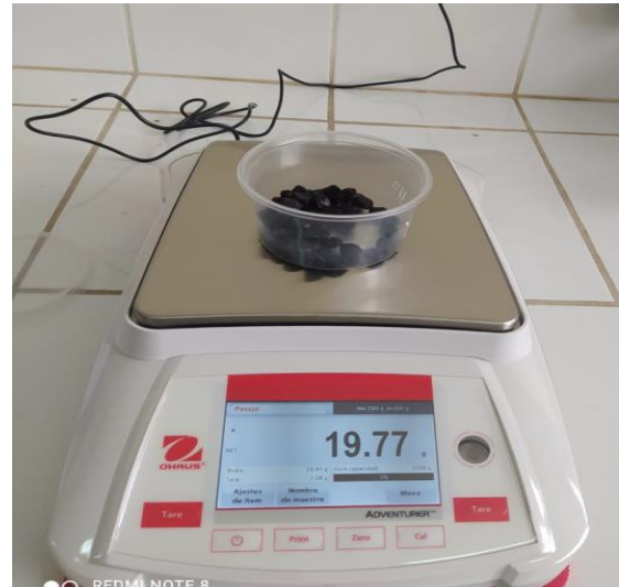
Foto 16. Determinación del peso de 1000 semillas
