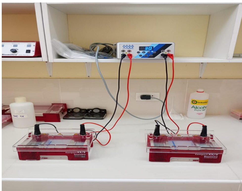
Instalación y programación de la cámara de electroforesis a 30 V por 3 horas.
