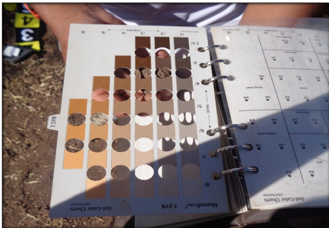
Figura 3.24. Reconocimiento del color en el suelo en húmedo, mediante el tablero de Munshell
