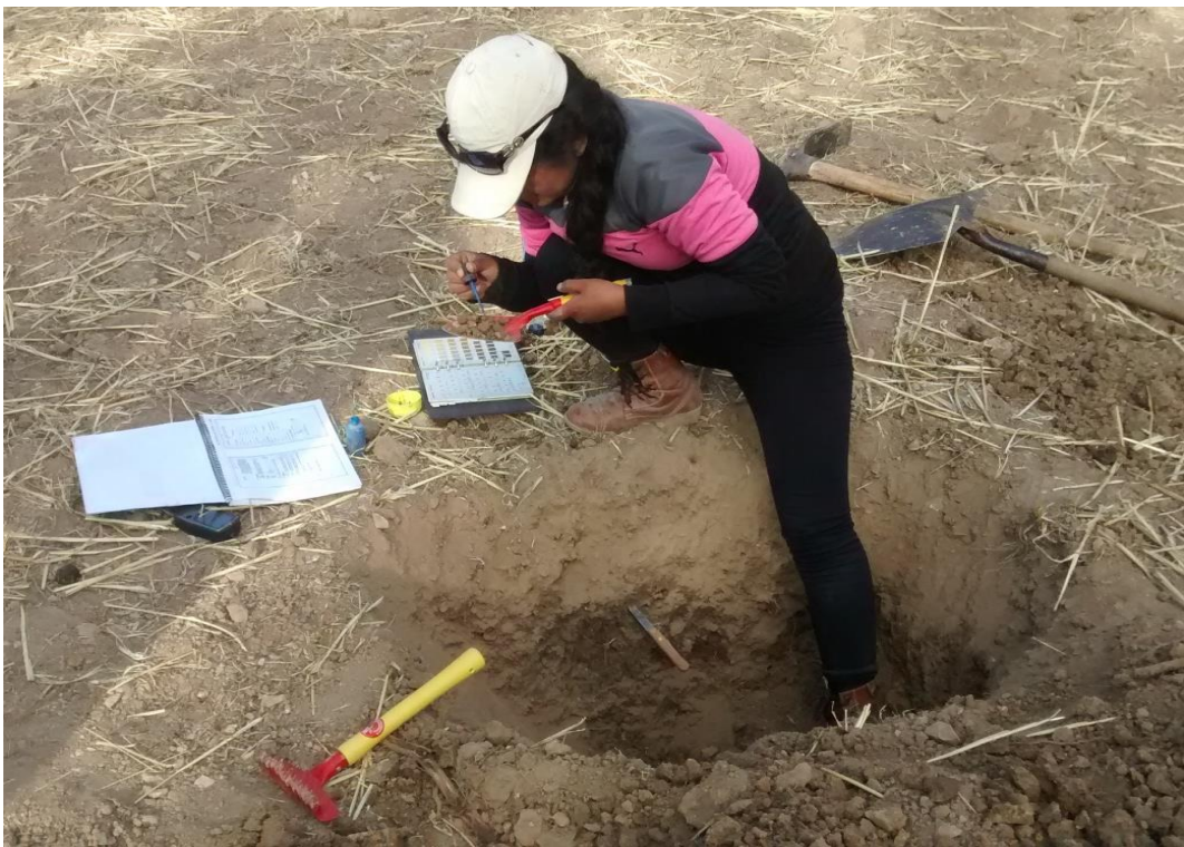
Foto 4.4. Evaluación y descripción de perfil del suelo, descripción de los agregados del suelo
