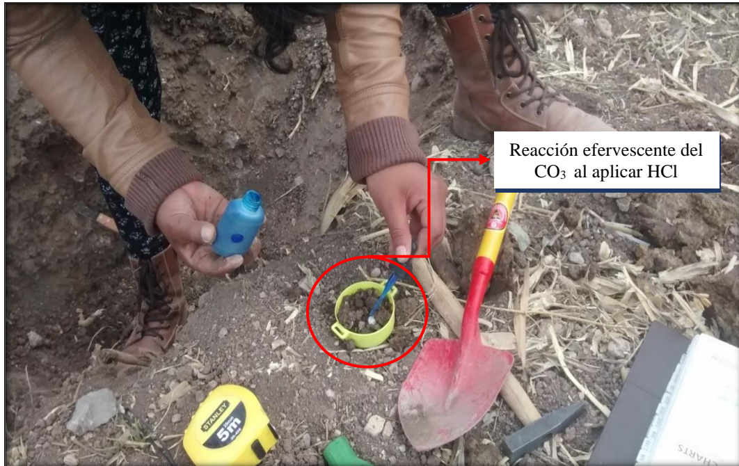
Figura 3.16. Prueba de presencia de carbonatos ( \text{CO}_3 ) en el suelo con ácido clorhídrico (HCl)
