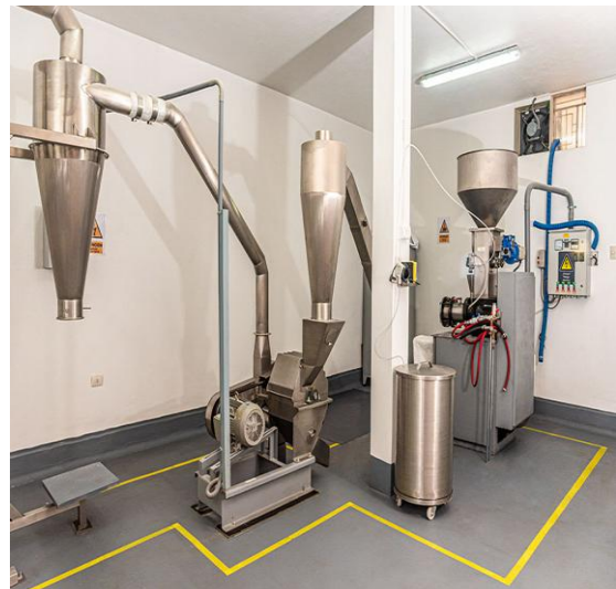
Figura N°10: Línea de maquinarias; extrusor, transportador neumático, molino de martillos.
