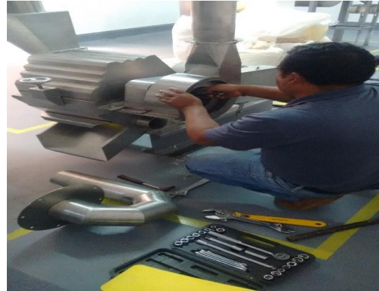
Figura N°02: Mantenimiento preventivo del molino de martillos (parte del rotor y eje).
