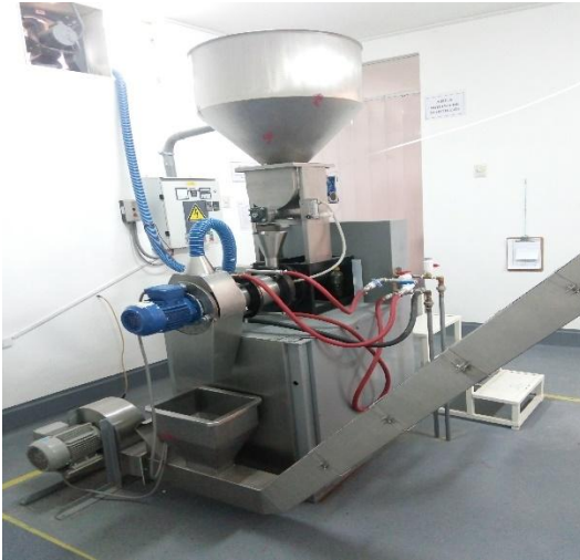
Figura N°07: Máquina extrusor acoplado al transportador neumático.
