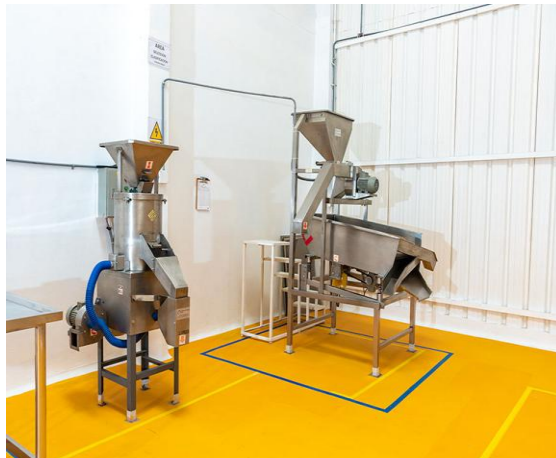
Figura N°02: Equipo seleccionadora clasificadora – zaranda (derecha) y equipo pelador de granos y semillas (izquierda).
