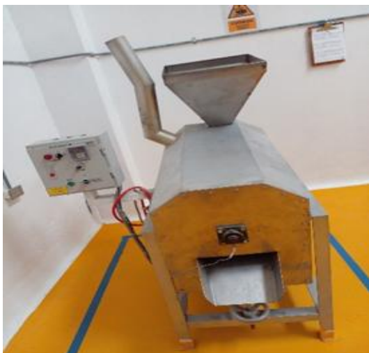
Figura N°03: Equipo tostador horizontal rotativo continuo.
