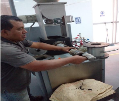
Figura N°01: Mantenimiento preventivo del extrusor (parte del tornillo sin fin - cañón). Sr. Alfredo – Técnico en mantenimiento de equipos.
