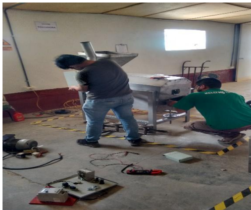
Figura N°05: Mejora y mantenimiento preventivo del tostador horizontal rotativo continuo (implementación de un tablero de control de parámetros y adición de paletas en el tambor de tostado). Sr. Alfredo – Técnico en mantenimiento de equipos y Sr. Yulex. Técnico electricista.
