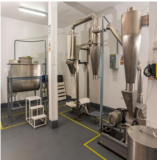
Figura N°09: Línea de maquinarias, molino de martillo y mezclador horizontal helicoidal.
