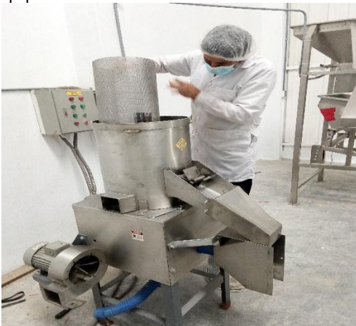
Figura N°03: Mantenimiento correctivo del pelador de granos y semillas (limpieza de malla). Personal: Oriol – Bach. Industrias Alim.
