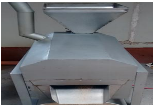
Foto inicial de la tostadora horizontal rotativo continuo, sin tablero ni mejoras.
