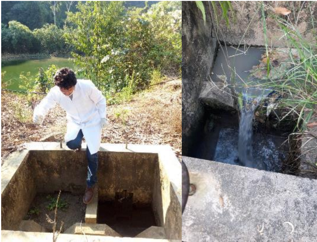
Figura 2.8. Medición del caudal (método del vertedero)
