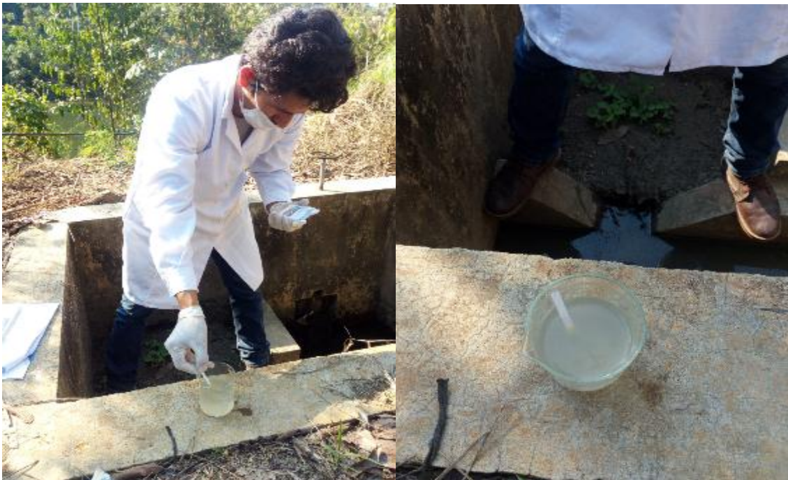
Figura 2.6. Determinación de pH en campo
