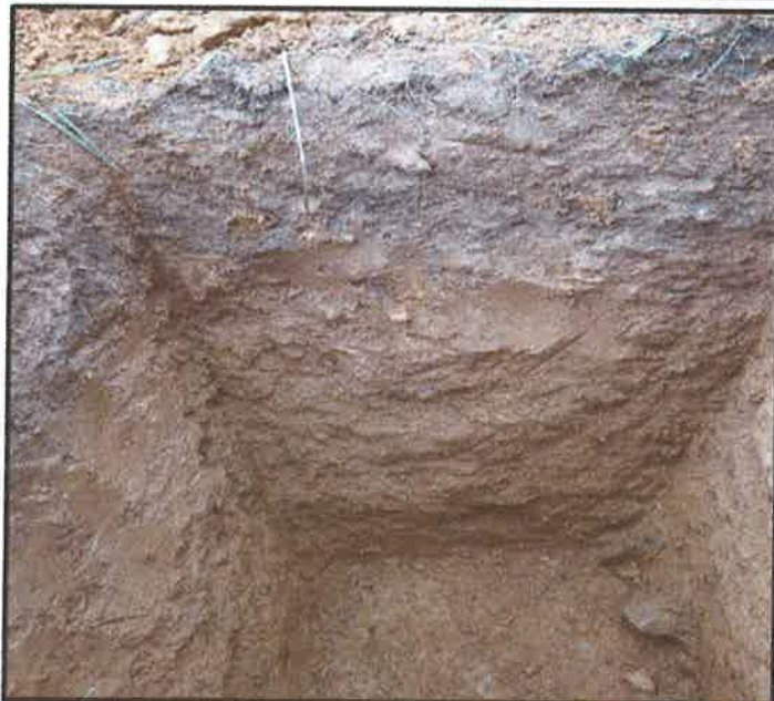
Imagen N° 03: Perfil estratigráfico de la Calicata C-01.
