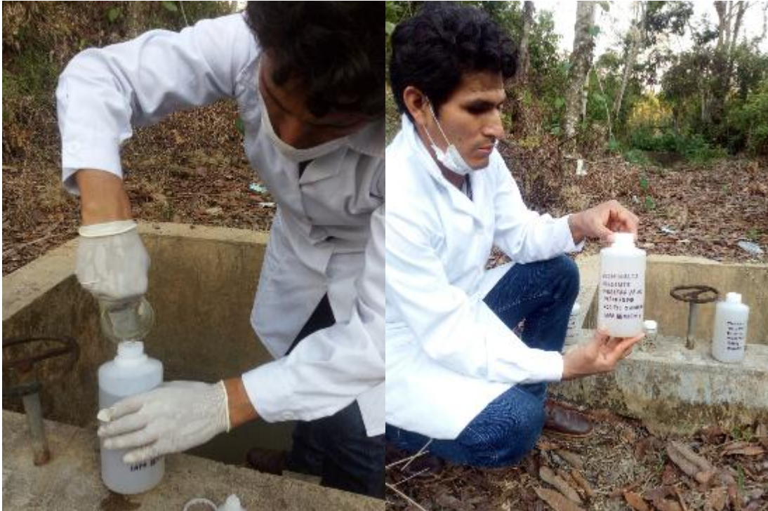
Figura 2.10. Extracción de muestras del afluente
