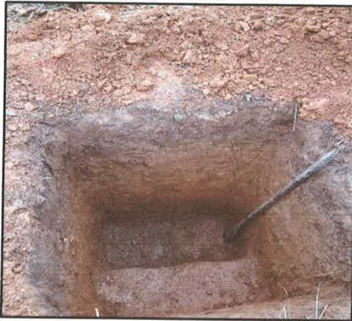
Imagen N° 05: material limo arcilloso encontrado en las exploraciones realizadas.
