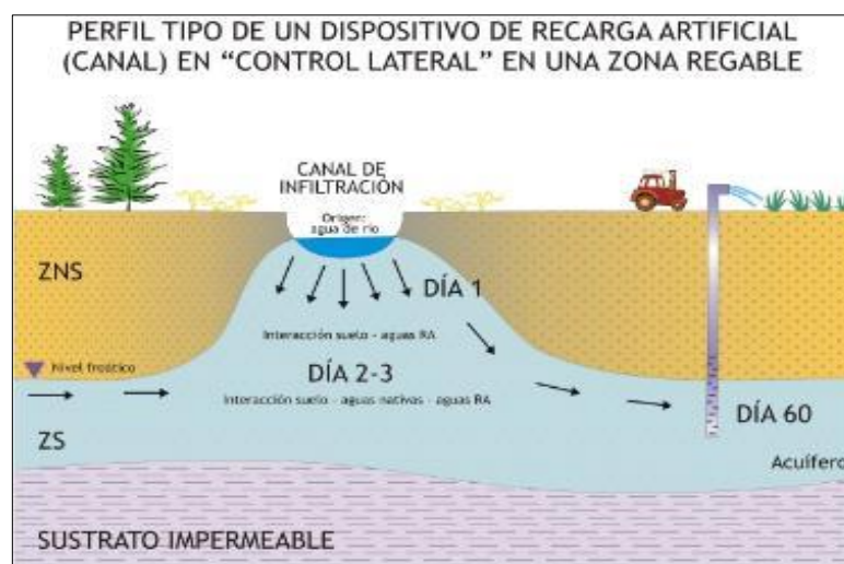
Figura 1.7. Recarga de acuíferos mediante canales de infiltración
