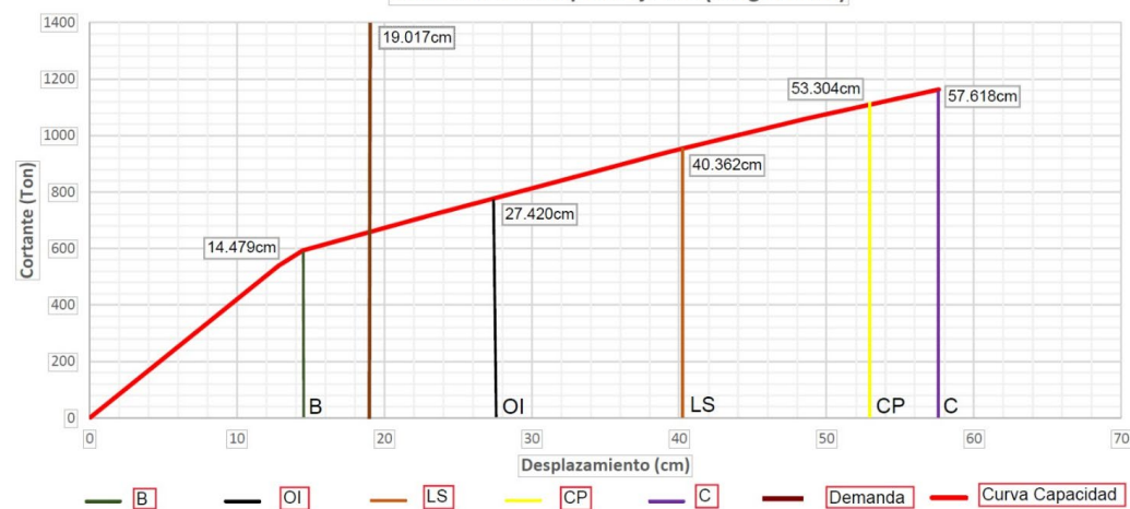
Figura 4.2: Estado límite en la dirección X (longitudinal) para un Tr=1000 años Límites de Desempeño eje X-X (Longitudinal)
