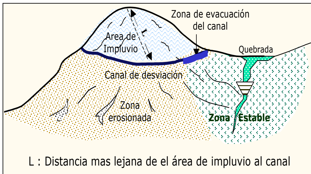
Figura No: 16 Partes del diseño de canal de desvío.
