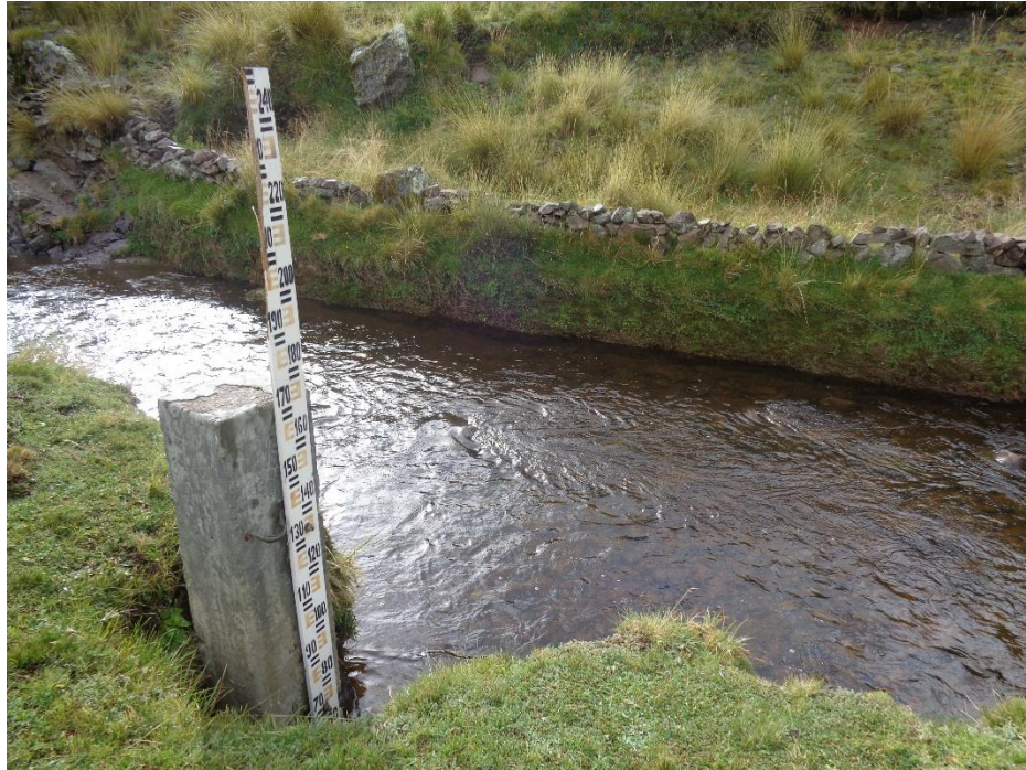
Figura No: 05 Modo de medir el caudal
