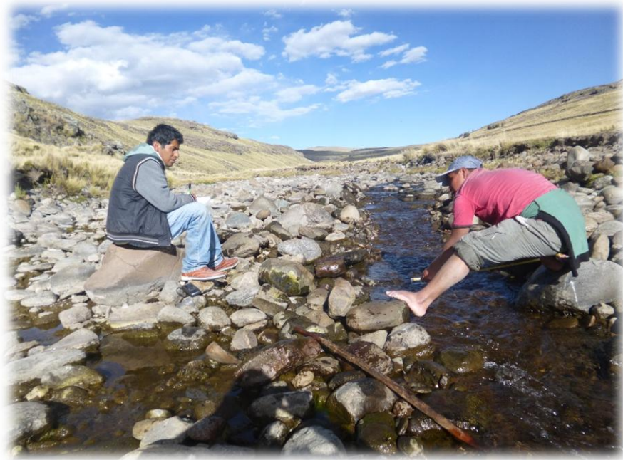
Figura No: 43 Aforo área velocidad
