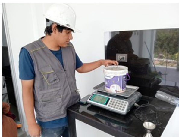
Figura N° 3.7: Peso de las tobas volcánicas
