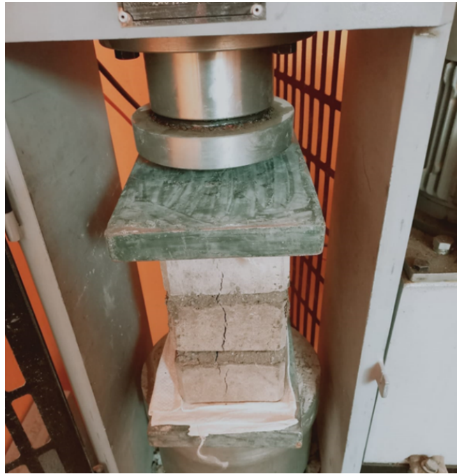
Figura N° 3.16: Ensayo a compresión de prismas
