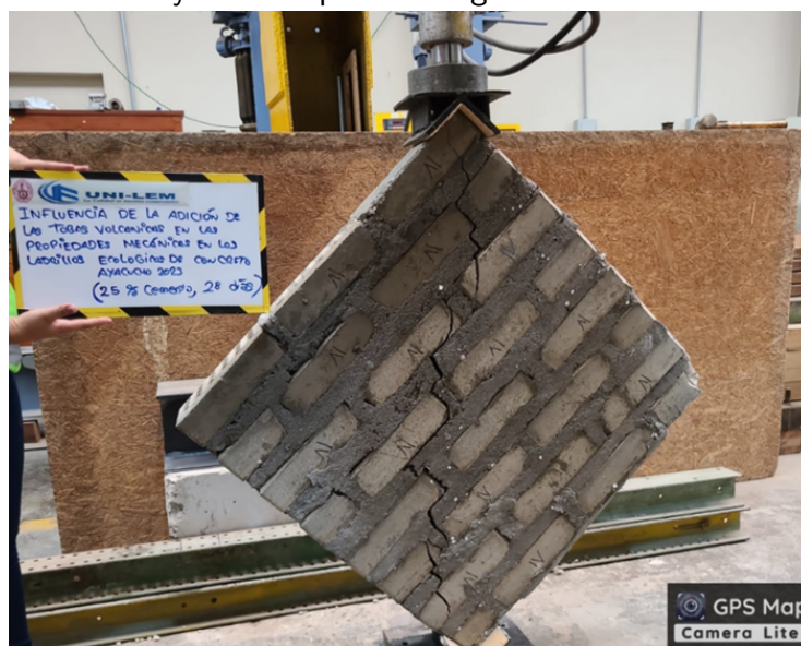
Figura N° 3.18: Ensayo de compresión diagonal de muretes
