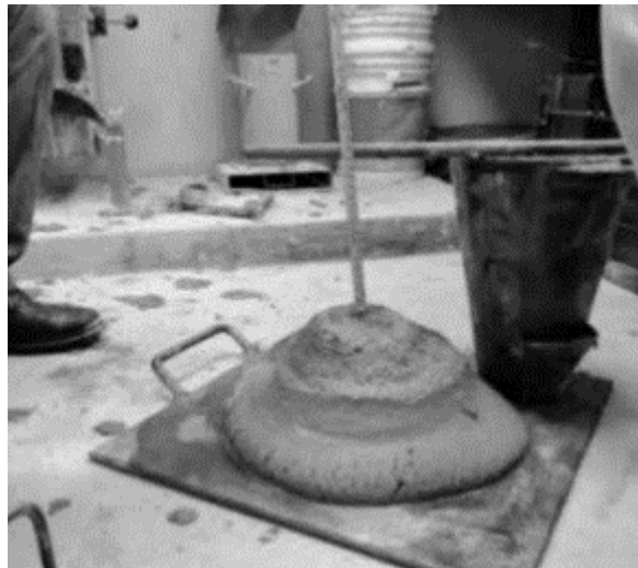
Figura N° 2.1: Ensayo de asentamiento
