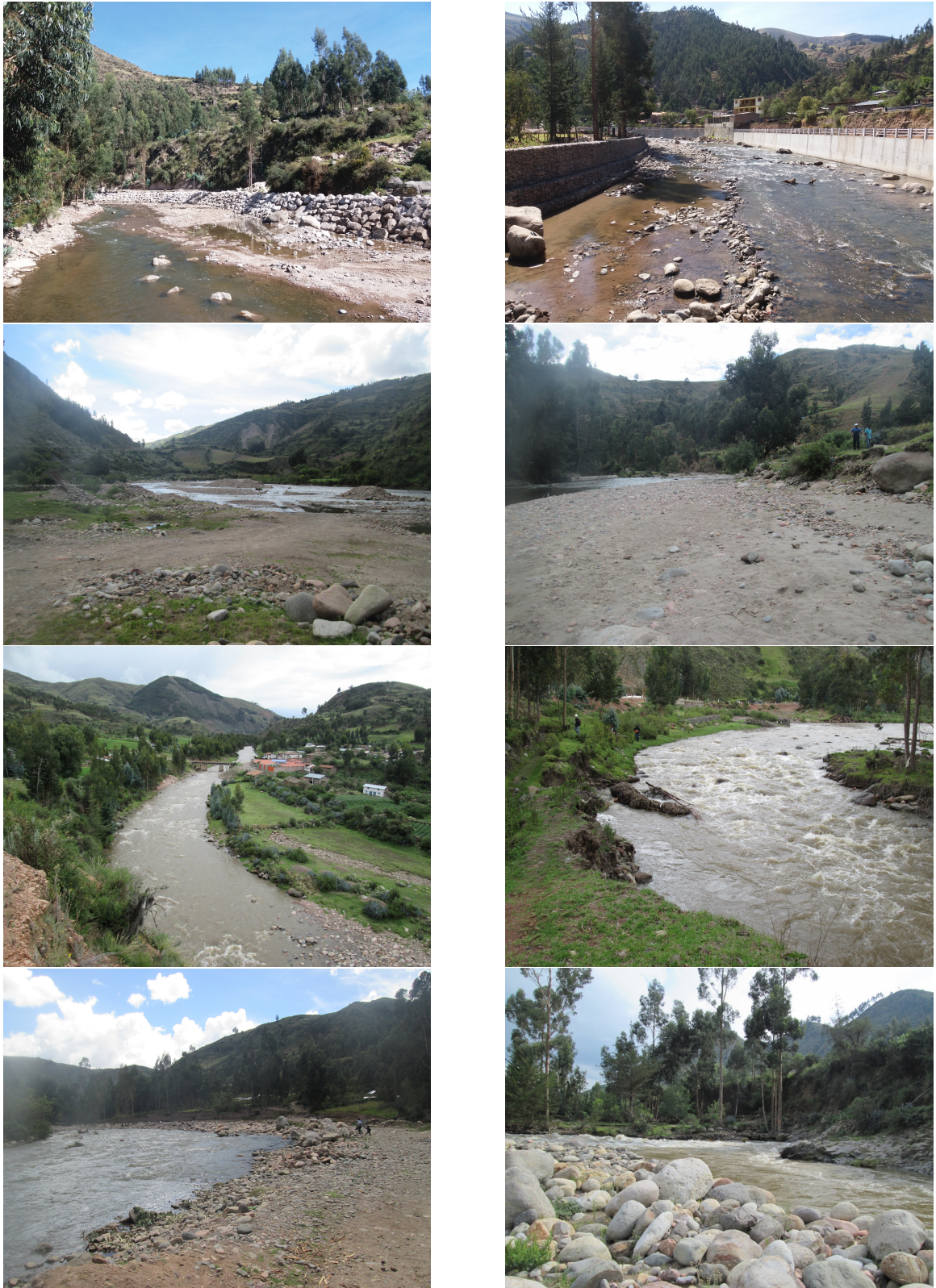
Figura N° 4.4: Río Vinchos, evaluación de los coeficientes de Rugosidad a lo largo del río.
