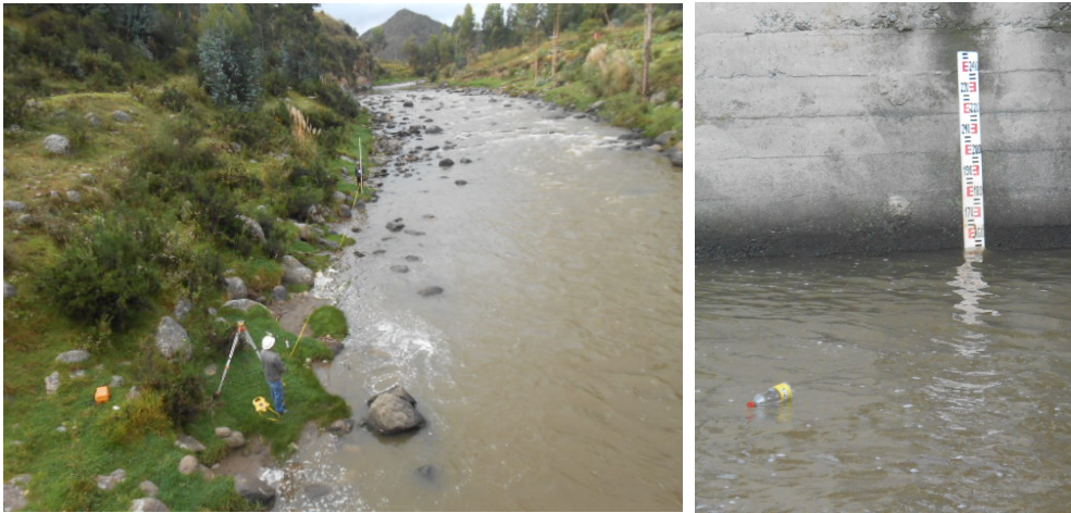
Figura N° 2.3: Aforo del caudal en el río Vinchos.
