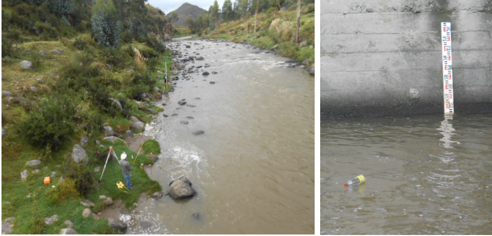
Figura N° 3.21: Aforo del caudal del río Vinchos (Estación Puente Casacancha).
