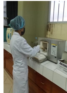
Poner las muestras en la mufla a 550°C por dos horas
