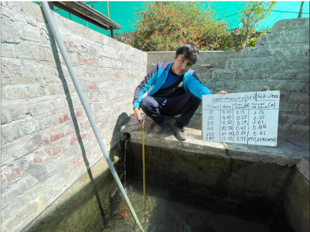
Figura 69 Medición del nivel dinámico del pozo con SFV
