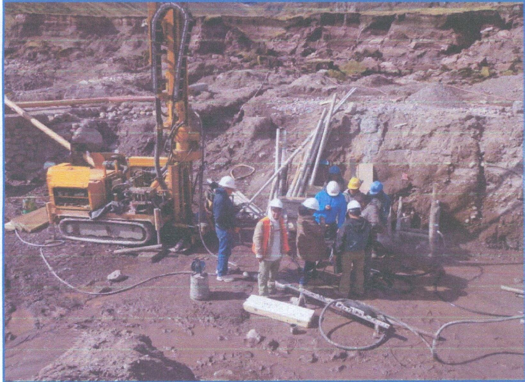
FCTOGRAFIA N° 04: Vista pruebas de permeabilidad (Ensayo de Lugeon).
