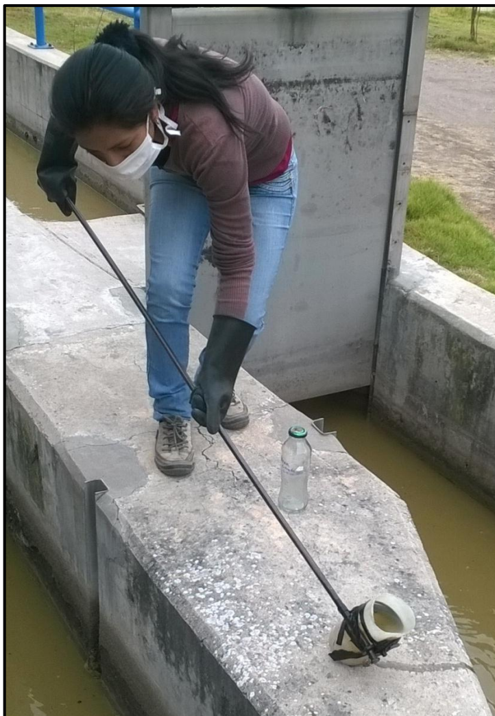
Anexo 3: Proceso de obtención de muestras de agua de la Planta de Tratamiento de Aguas Residuales “La Totora”. Ayacucho 2016.
