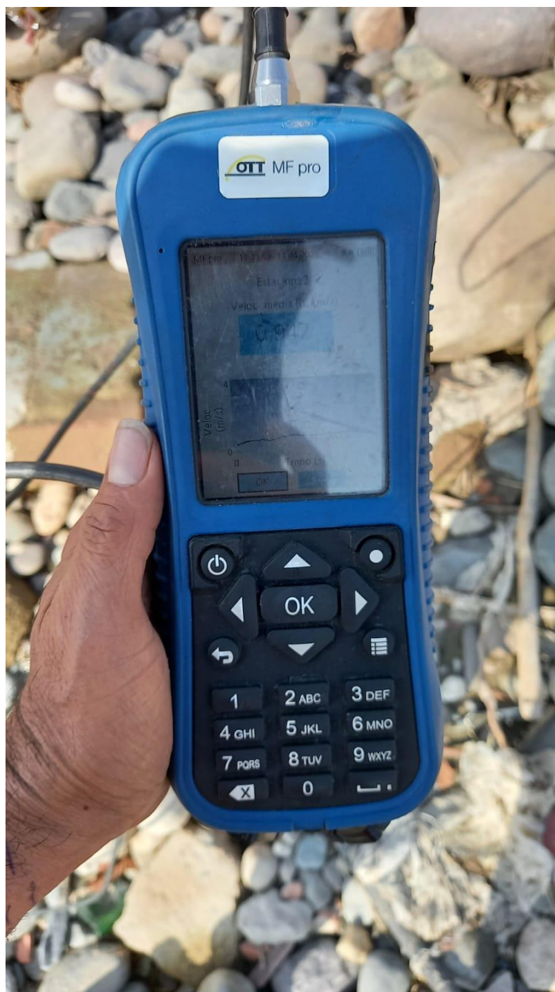
Fotografía 3. Medición de velocidad del flujo en el río Chancay – Huaral con equipo OTT MF Pro
