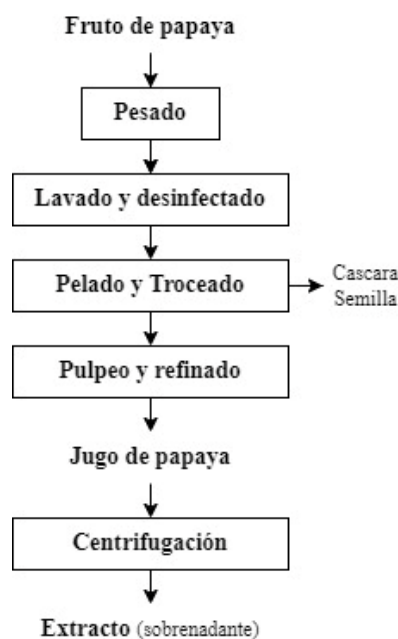
Figura 11 Flujo de proceso de obtención de extracto de papaya.
