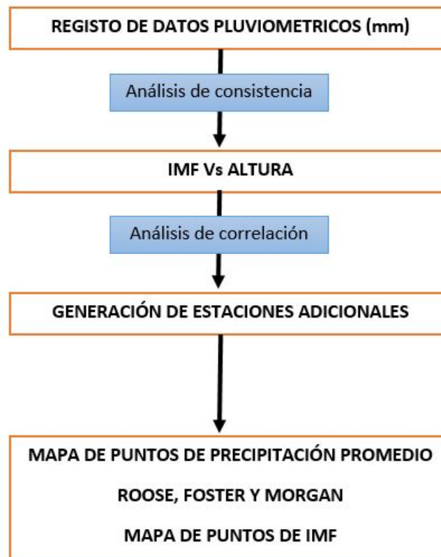
Figura 3.61: Flujograma para la obtención del mapa de erosividad de la lluvia.
