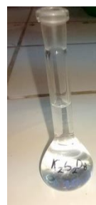
Se pesó 7 mg de Persulfato de potasio y se aforó en 10 mL de agua destilada
