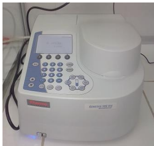
Se hicieron lecturas de las absorbancias en el espectrofotómetro a 515 nm
