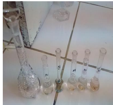
Se realizó diluciones de 0,5; 1; 2; 3; 4 mL y se aforó a 10 mL de etanol
