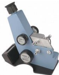
Refractómetro de ABBE 5 refractometer Bellingham + Stanley Ltd, modelo A11
