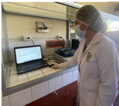
3. Se inyecta oxígeno en la cámara hasta alcanzar una presión de 6 bar, estableciendo la temperatura del reactor.
