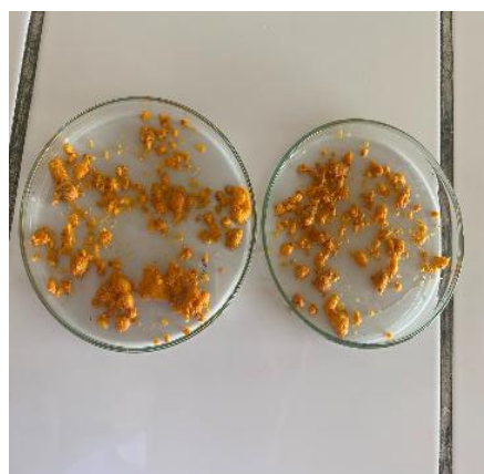
4. Se registro el peso final para el cálculo del porcentaje de humedad. El análisis se realizó por duplicado.
