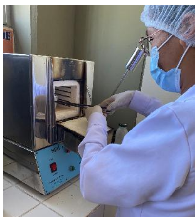
3. La muestra se llevó a mufla a 550°C durante 4 h aprox
