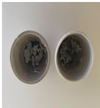
4. Se registró el peso final para el cálculo del porcentaje de ceniza. El análisis se realizó por duplicado.
