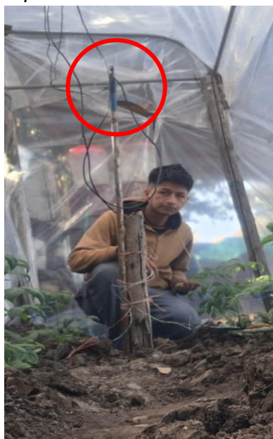
Instalación del sensor de temperatura DHT11
